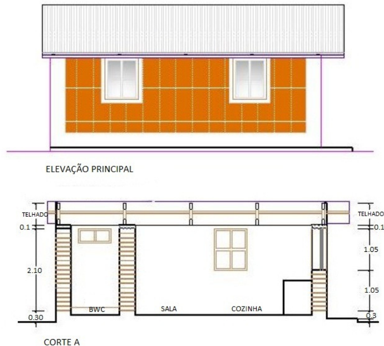
Figura 2.2.2 - Projeto da unidade de habitação rural de Ruruca – elevação e corte
