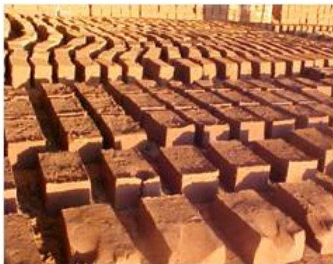
Figuras 2.3.2.4 - Tijolos de adobe - construção da unidade habitacional com este material
