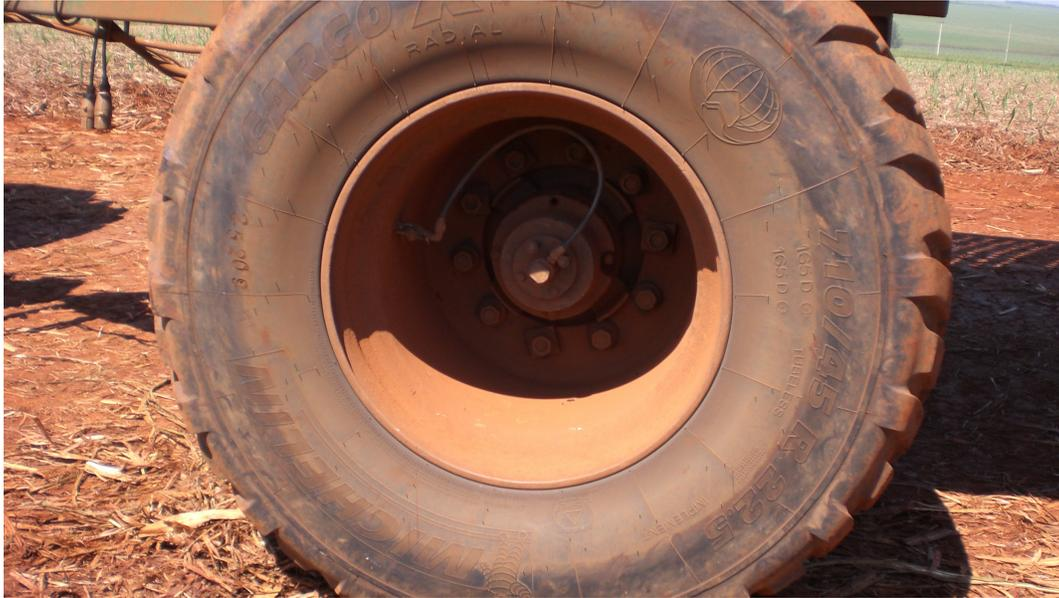
Figura 3 - Pneu do trator da UFRA com controle de pressão.
