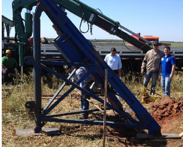
Figura 25 – Tripé para aplicação das cargas axiais da estaca
