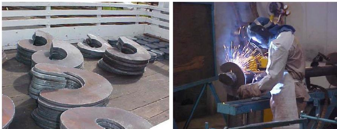
Figura 6 a) hélices b) soldagem das hélices no eixo Fonte: (Carvalho 2007).
