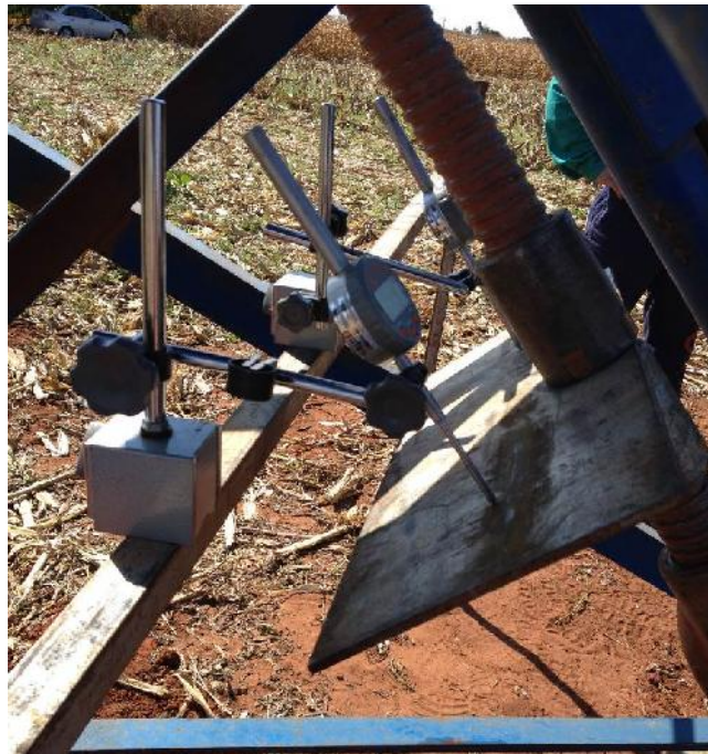
Figura 26 - Detalhe do equipamento para aferição do deslocamento da estaca
