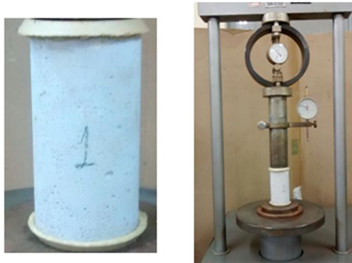
**Figura 22 - Rompimento de corpos-de-prova de argamassa**
