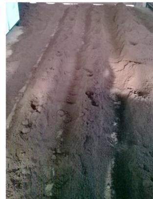
**Figura 16 – Solo peneirado sobre lastro de concreto**
