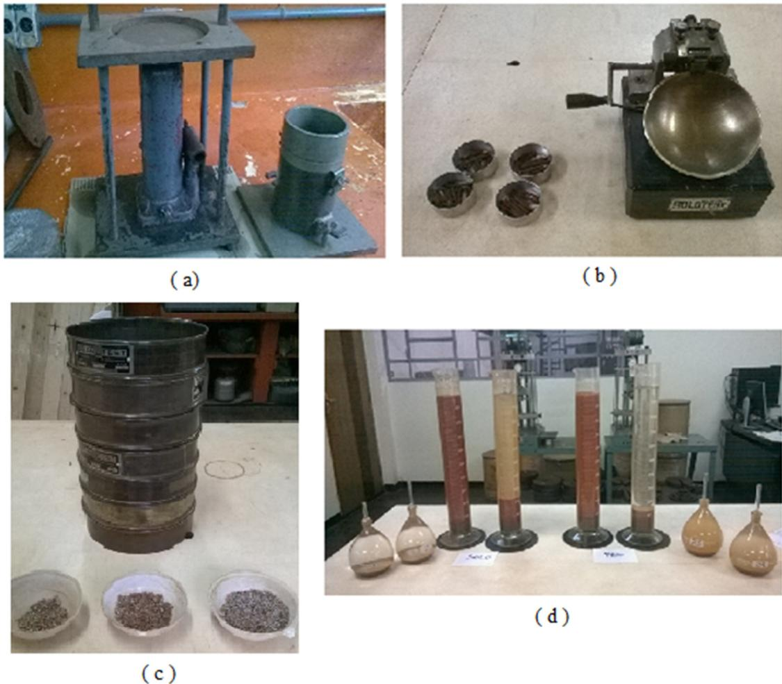
Figura 18 - Ensaio de caracterização dos solos: (a) Compactação; (b) Limite de liquidez; (c) Peneiramento e (d) Sedimentação e massa específica dos grãos.
