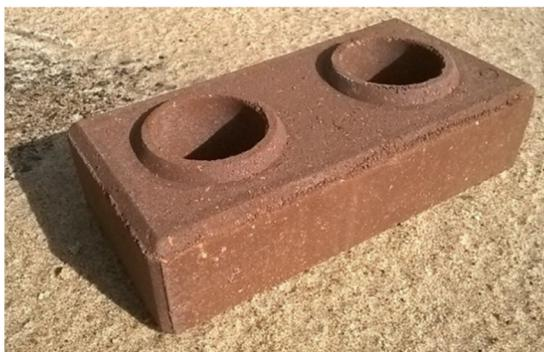
**Figura 4 - Exemplar de tijolo de solo-cimento-RCC**
