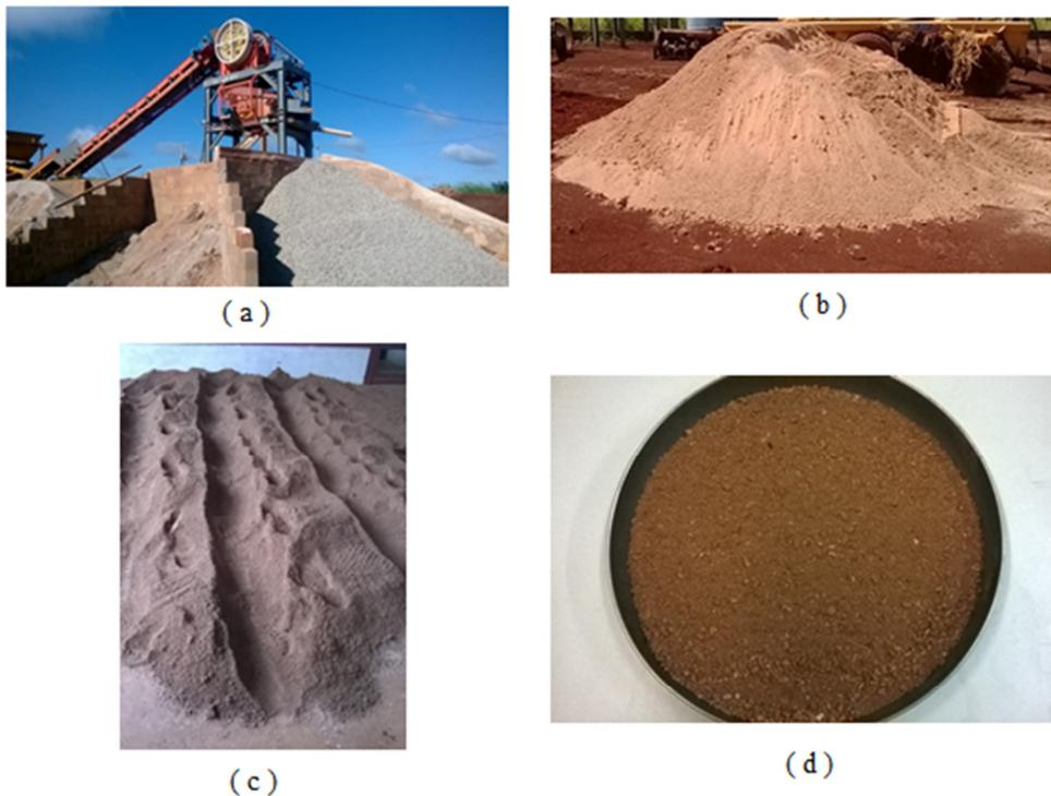
Figura 17 - Etapas de preparo do Resíduo da Construção Civil (RCC) - (a) Processo de fabricação do RCC; (b) RCC coletado; (c) RCC peneirado sobre lastro de concreto e (d) Amostra de RCC
