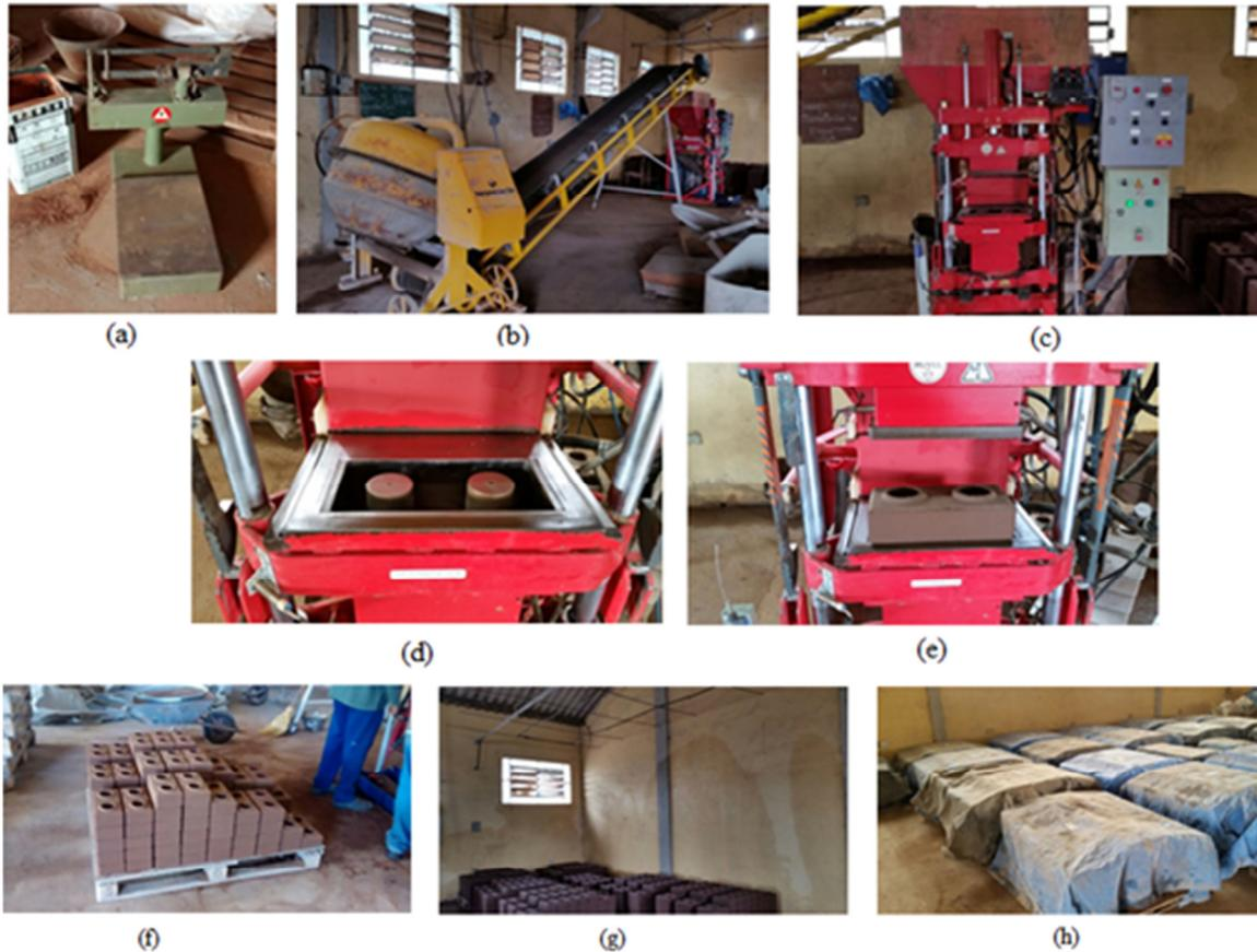
**Figura 19 - Processo de fabricação dos tijolos**
