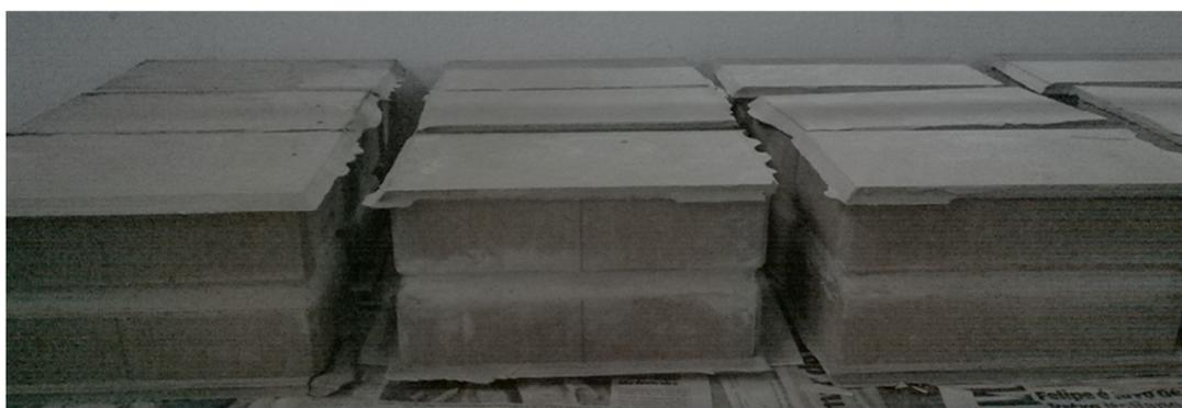
**Figura 24 - Prismas preparados para o ensaio de resistência à compressão**
