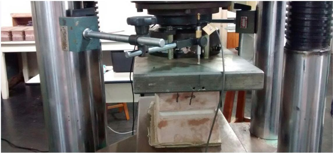
**Figura 28 - Instrumentação dos prismas**
