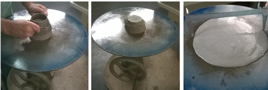
**Figura 23 - Ensaio da trabalhabilidade da argamassa - mesa de consistência**
