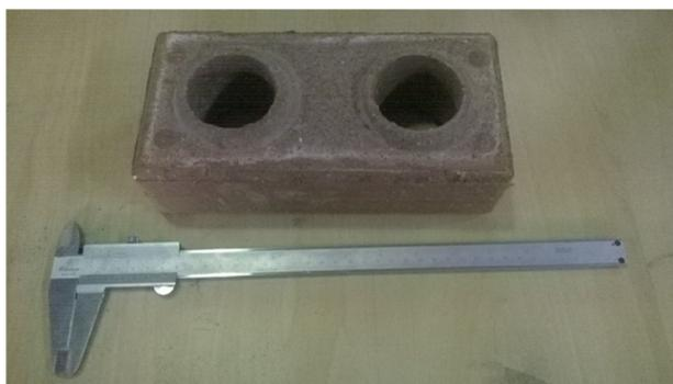
**Figura 20 - Ensaio de análise dimensional de tijolo de solo-cimento-RCC**
