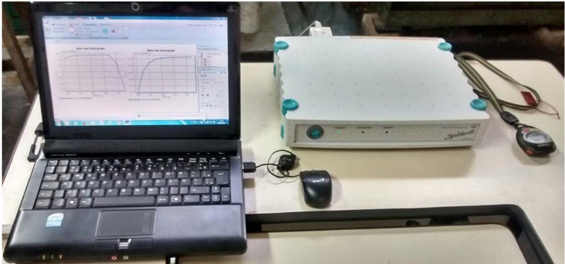
**Figura 29 - Sistema de aquisição de dados de deslocamentos**
