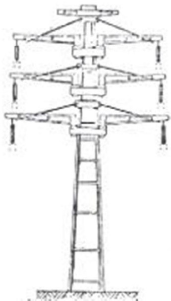
Figura 3.2: Estrutura autoportante de concreto de uma linha de transmissão
