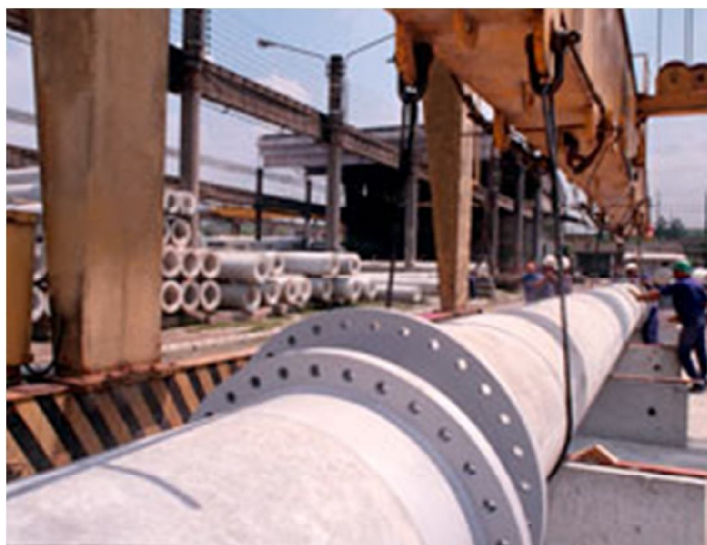
Figura 2.1: Detalhe de flange e estação de alinhamento (fábrica)
