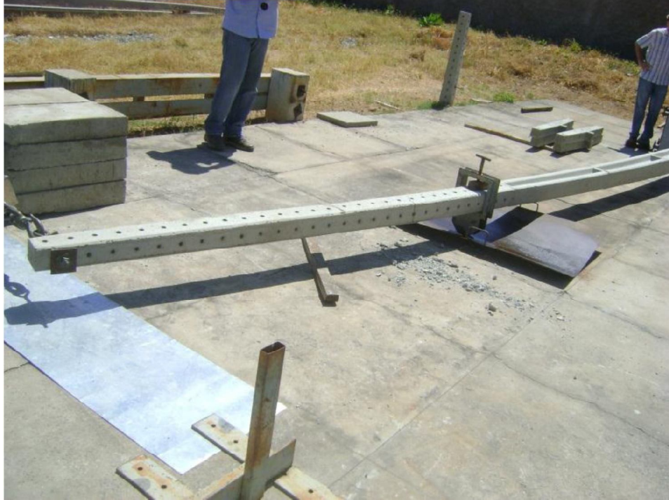
Figura 2.22: Ensaio de poste de concreto
