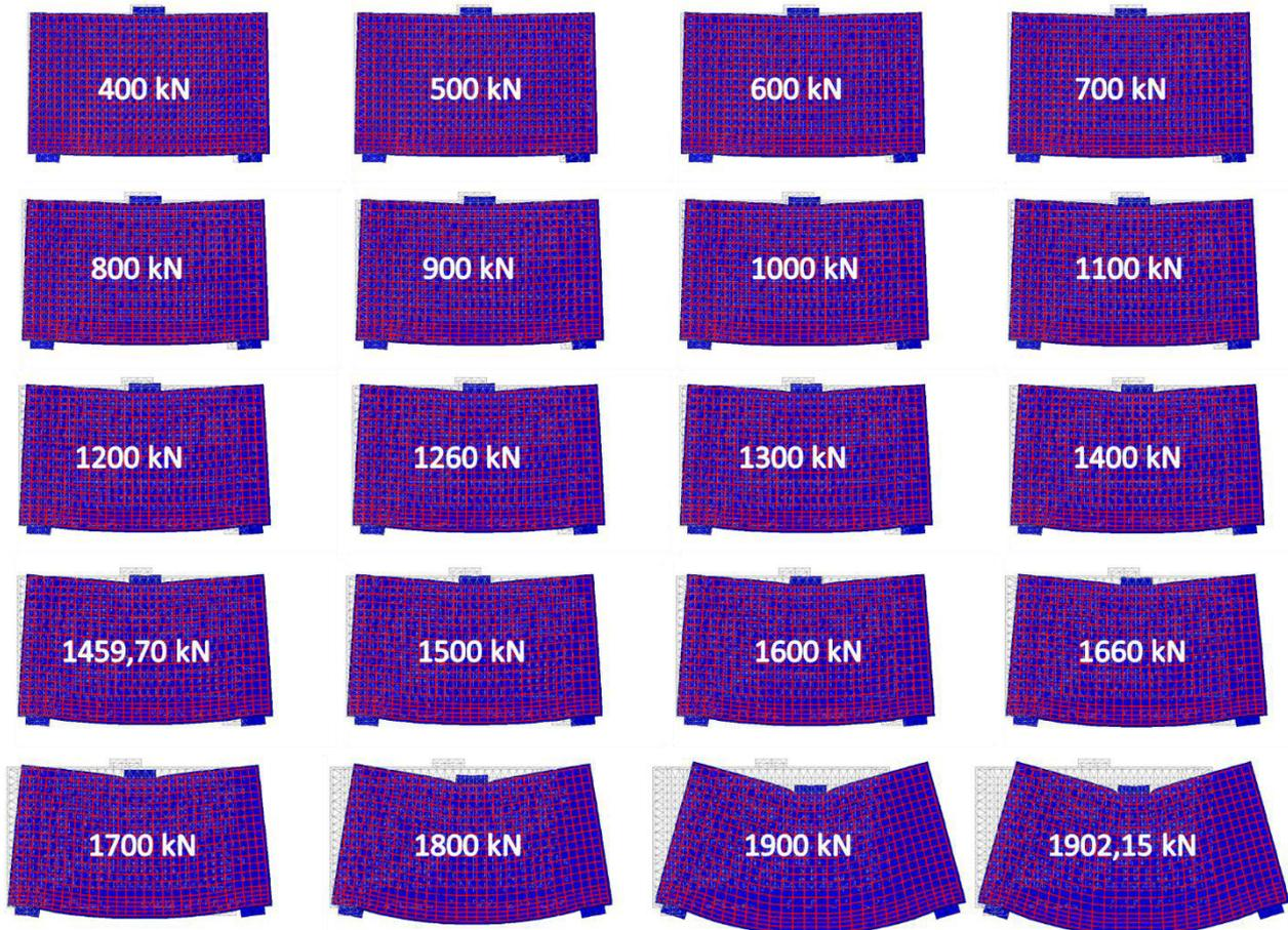
Figura 8.126 - Diagrama *Deformed* viga-parede modelada segundo MCT.
