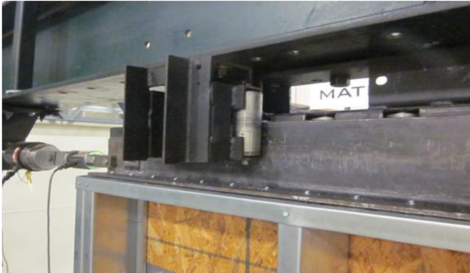
Figura 3.18 – Detalhe do sistema de suporte fora do plano
