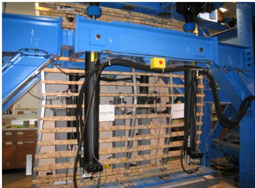
Figura 3.4 – Ensaio em escala real de um painel apenas com tiras de OSB
