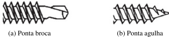
Figura 2.6 – Tipos de pontas dos parafusos auto brocantes
