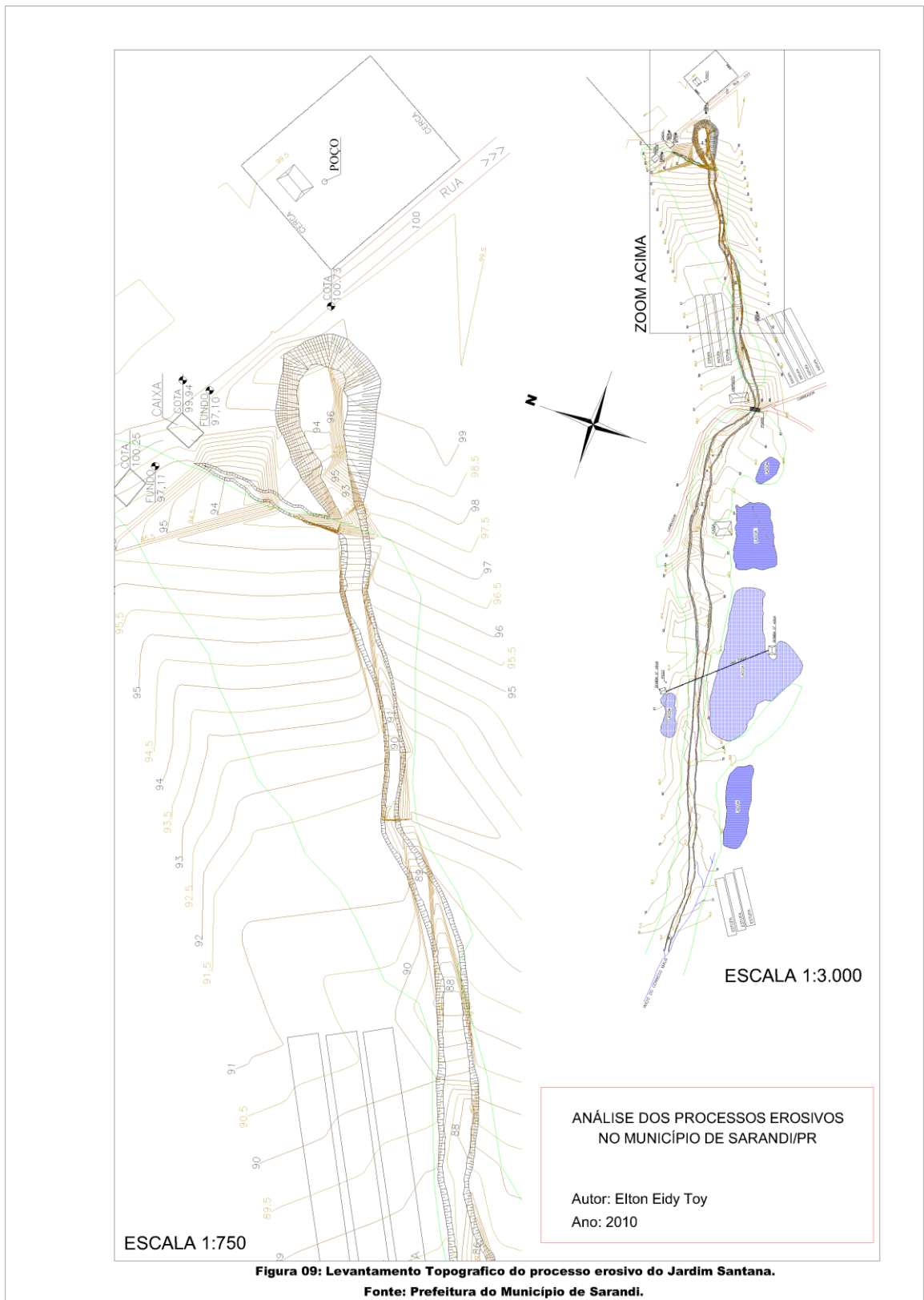
Figura 09: Levantamento Topográfico do processo erosivo do Jardim Santana.
