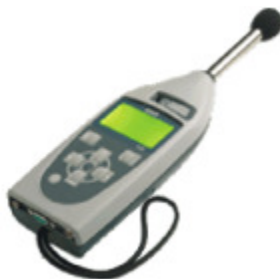
Figura 3.2 - Medidor de nível de pressão sonora, 01dB® Fonte: Acervo da autora
