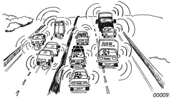
Figura 2.2 - Exemplo de fonte linear Fonte: Brüel e Kjør, 2000.
