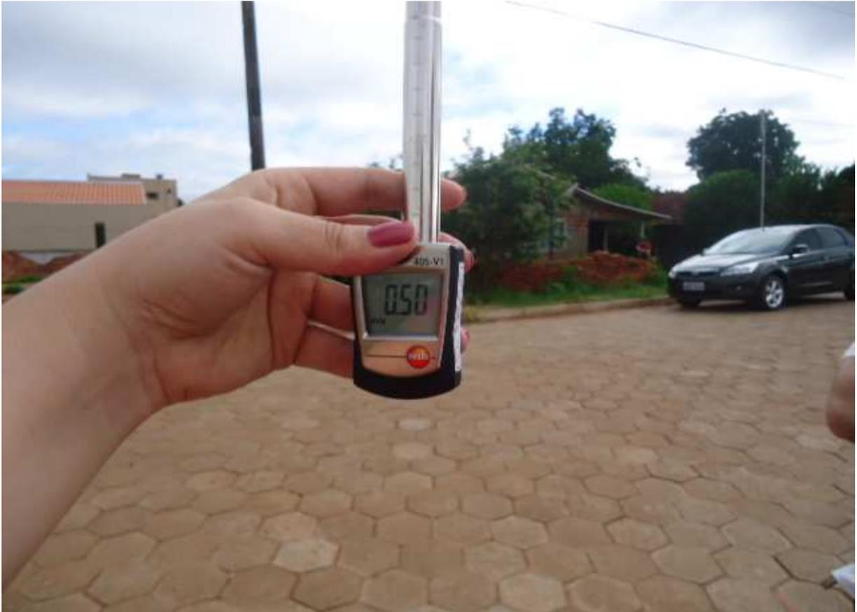
**Figura 8.13 – Medidor da velocidade do vento**
