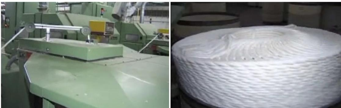
Figura 20 - Processo de Carda
