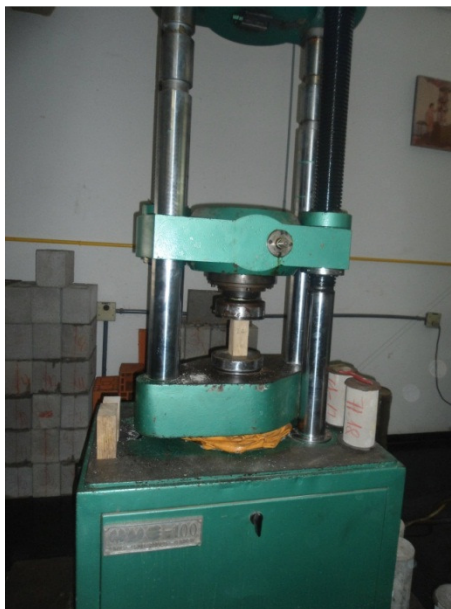
Figura 46 - Corpo de prova na prensa hidráulica
