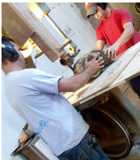
Figura 37 - Corte da espécie Tipuana, na máquina serra fita
