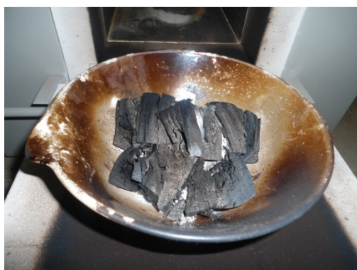
Figura 51 - Tipuana após a queima em Mufla a 450° C
