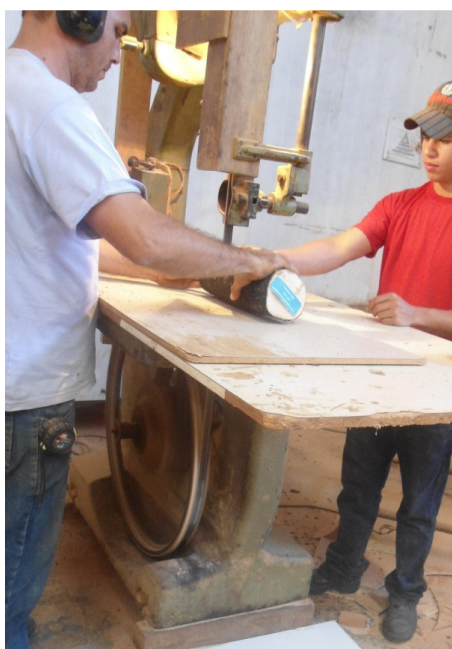
Figura 38 - Corte da espécie Sibipiruna, na máquina serra fita
