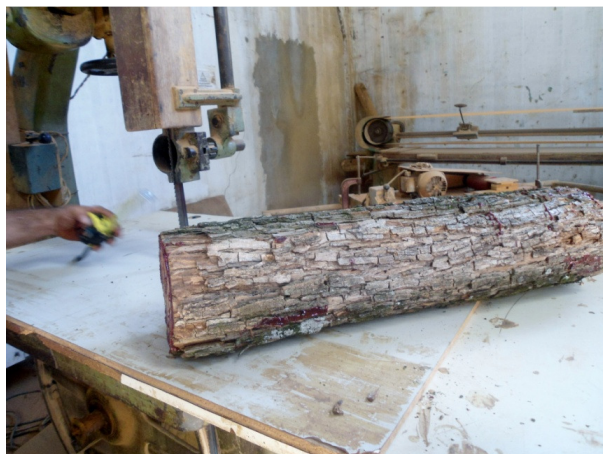
Figura 39 - Corte da espécie Ipê Roxo na máquina serra fita
