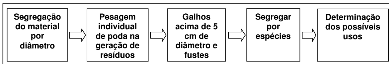
Figura 35 - Método de coleta e separação das amostras da madeira de poda
