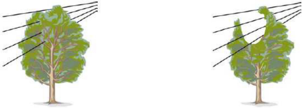
Figura 18 - Rede secundária (baixa tensão) convencional antes da poda da árvore e Rede secundária (baixa tensão) após a poda da árvore Fonte: Copel, 2009
