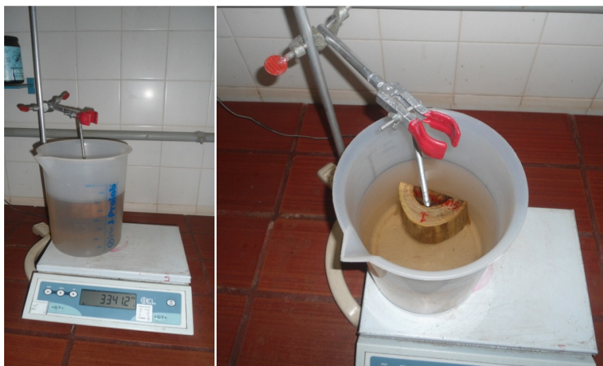
Figura 40 - Ensaio de determinação da densidade básica
