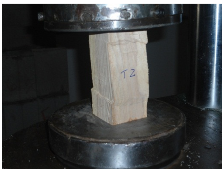
Figura 47 - Corpo de prova que se rompeu após tensão exercida pela prensa hidráulica
