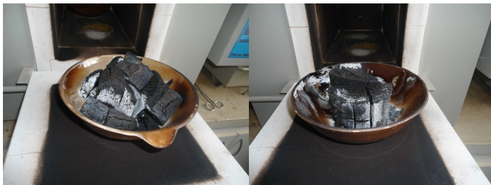
Figura 50 - Ipê Roxo e Sibipiruna após a queima em Mufla a 450° C
