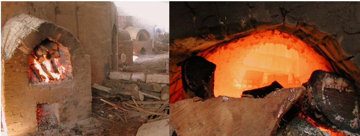
Figura 3.7 - Forno tipo Hoffman para queima dos blocos cerâmicos
