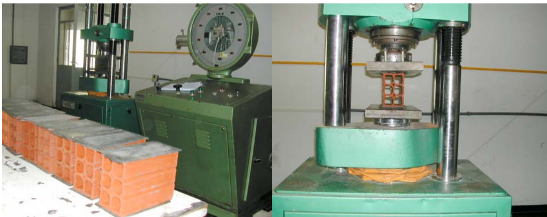
Figura 3.14 – Equipamento para ensaio de resistência à compressão - bloco cerâmico em escala real.
