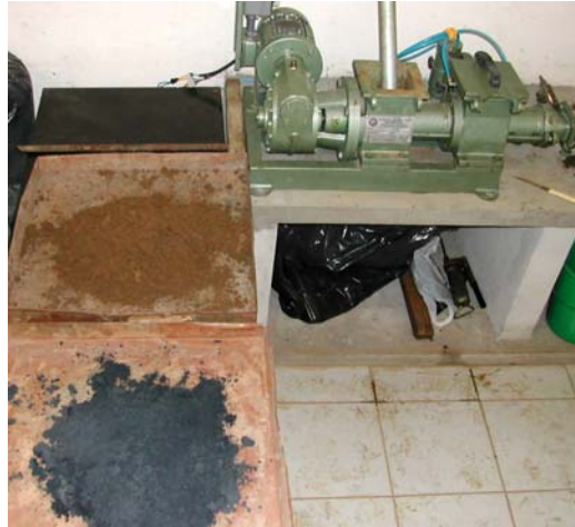
Figura 3.4 - Mistura do lodo com argila para produção dos blocos cerâmicos
