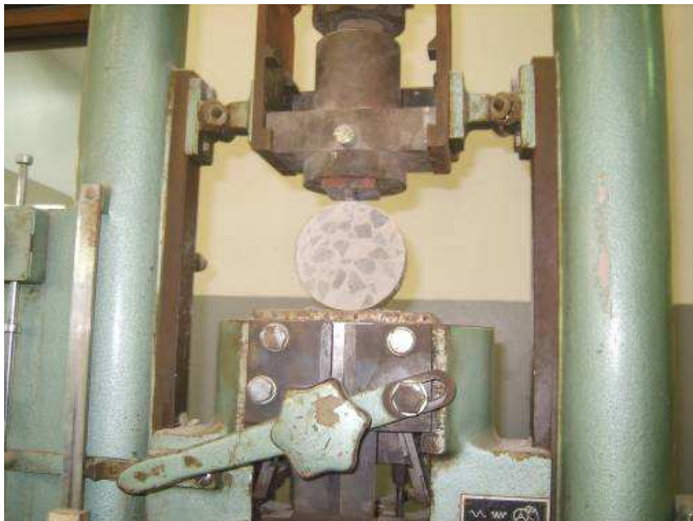
Figura 34 - Rompimento para medida da frente de carbonatação
