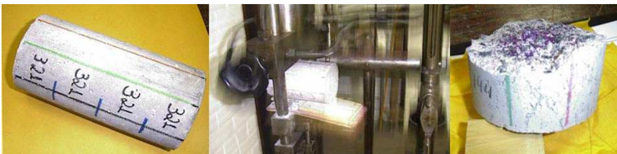
Figura 23- Corte dos corpos-de-prova
