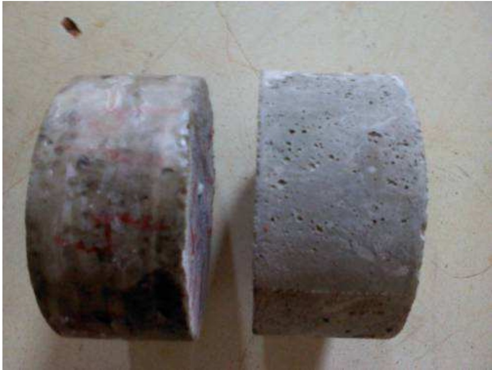
Figura 31 - Amostra impermeabilizada (a esquerda) e não impermeabilizada (a direita)
