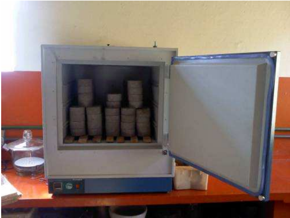
Figura 30 - Pré-condicionamento das amostras
