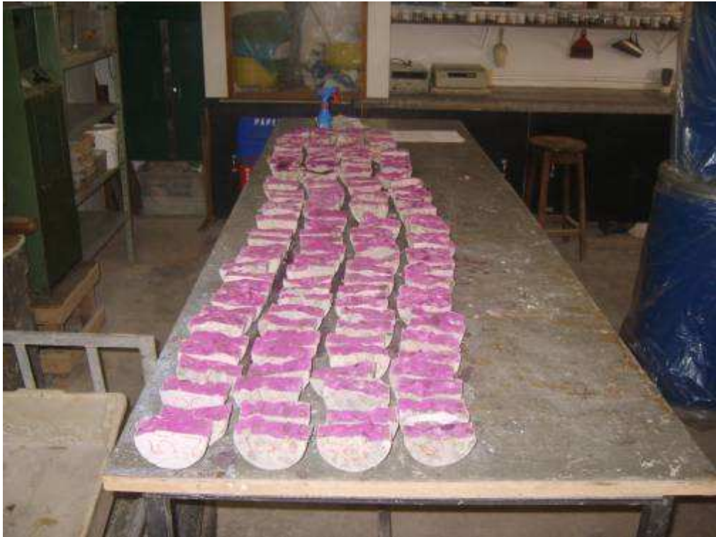
Figura 35 - Aspersão de fenolftaleína
