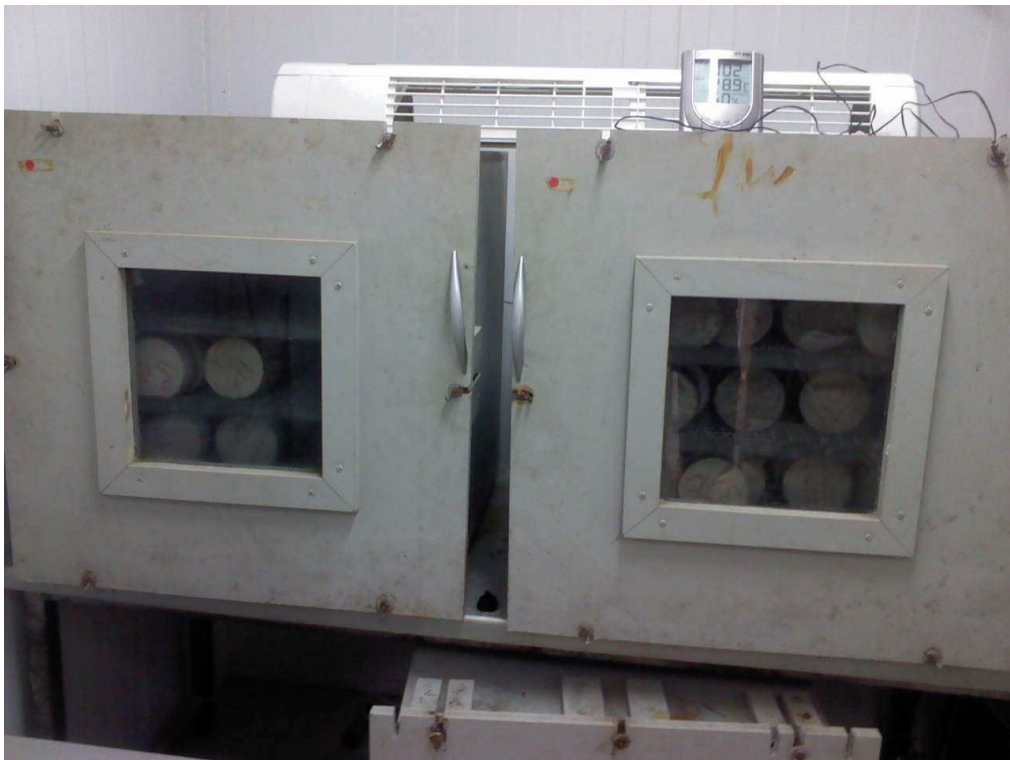
Figura 33 - As duas câmaras de carbonatação
