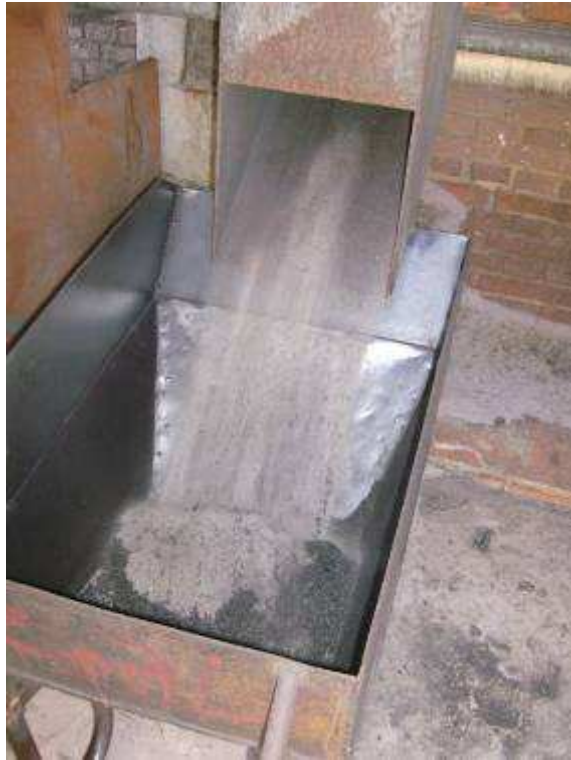
Figura 18 - Eliminação da cinza retida no sistema de chicanas
