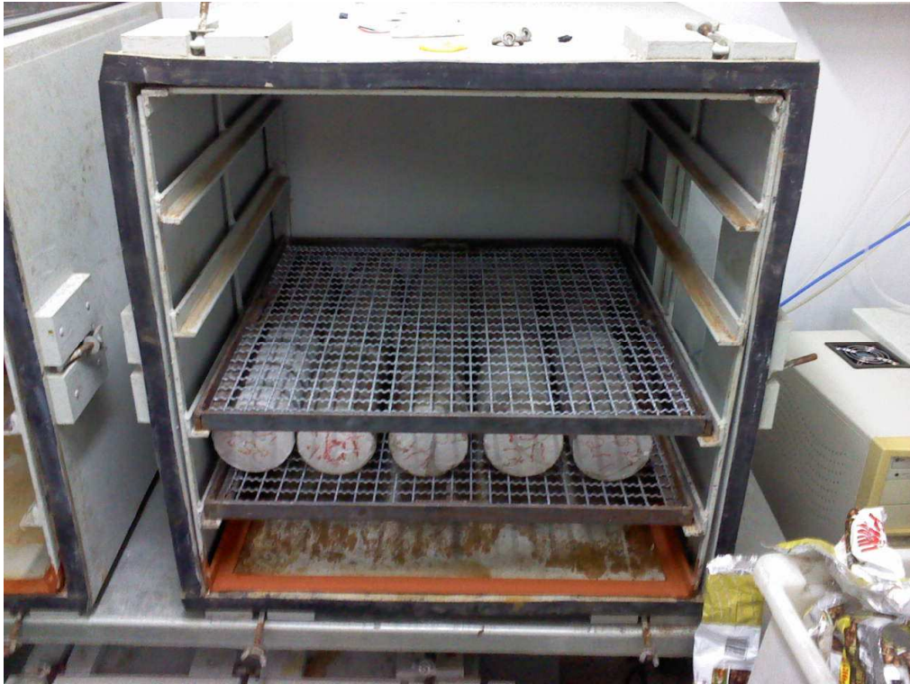
Figura 32 - Câmara de carbonatação 1 sendo preenchida com os CP's
