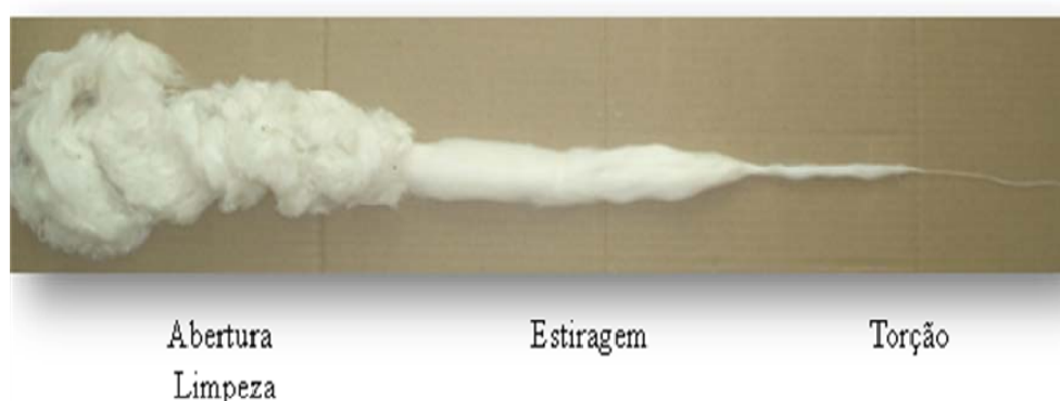
Figura 8: Etapas de fiação para fibras descontínuas
