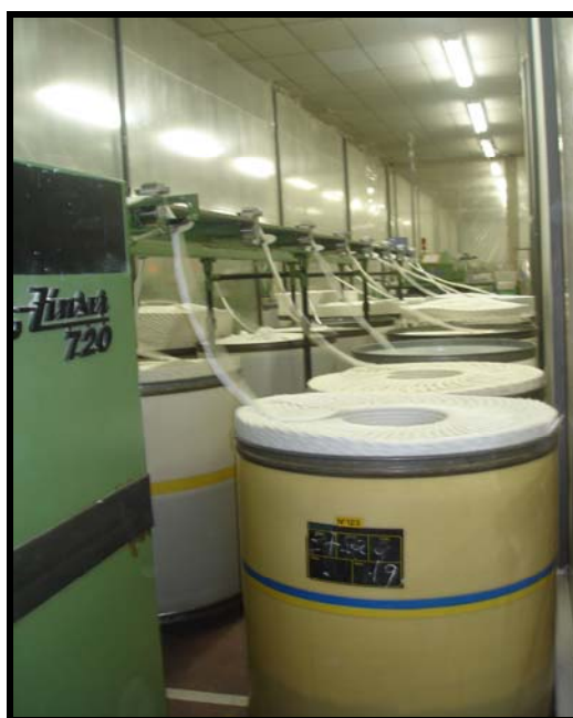
Figura 41: Abastecimento das latas de fitas de poliéster e algodão
