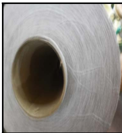
Figura 57: Rocas com defeito de enrolamento
