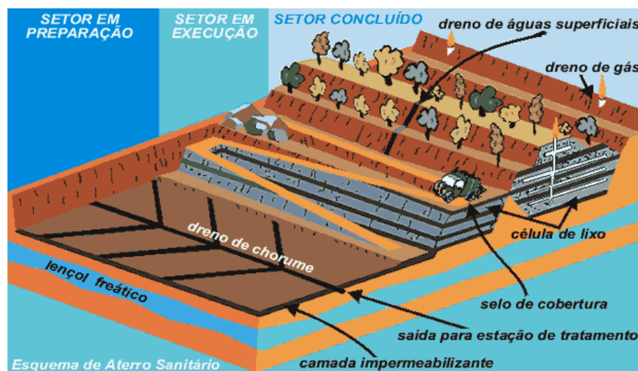
Figura 12 - Corte esquemático de um aterro sanitário
