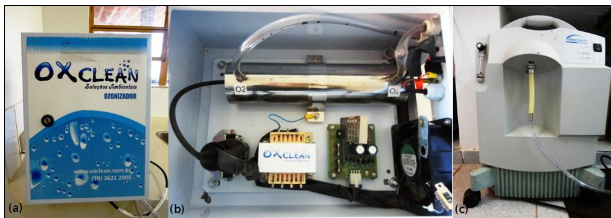
Figura 14 – (a) e (b) Imagem da estrutura do gerador de ozônio e (c) concentrador de oxigênio
