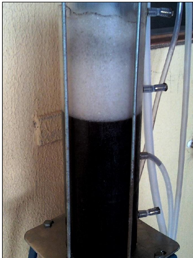
Figura 20 – Imagem do reator com a espuma formada no reator de ozonização
