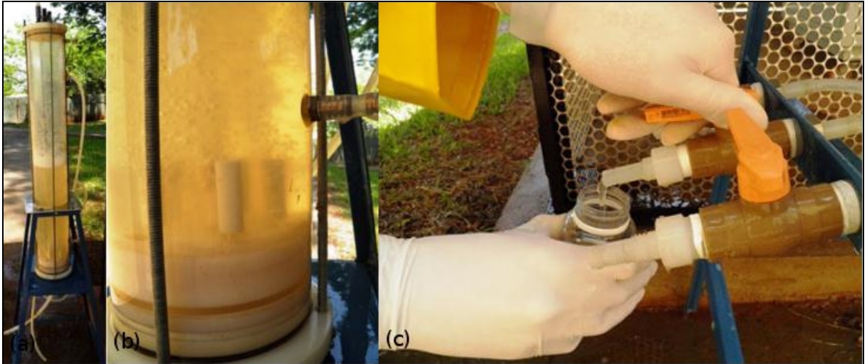
Figura 15 – Imagem da coluna de ozonização preenchida com Lixiviado (a) coluna (b) pedras porosas (c) coleta das amostras
