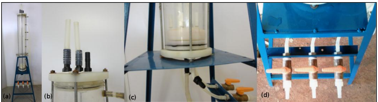
Figura 13 - Coluna de ozonização (a) coluna (b) topo da coluna (c) entrada do gás ozônio (d) sistema de coleta
