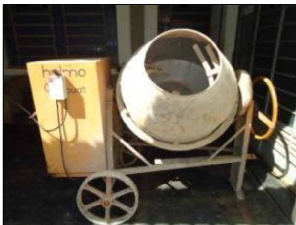
Figura 25 – Betoneira de 400 litros usada na preparação do concreto.
