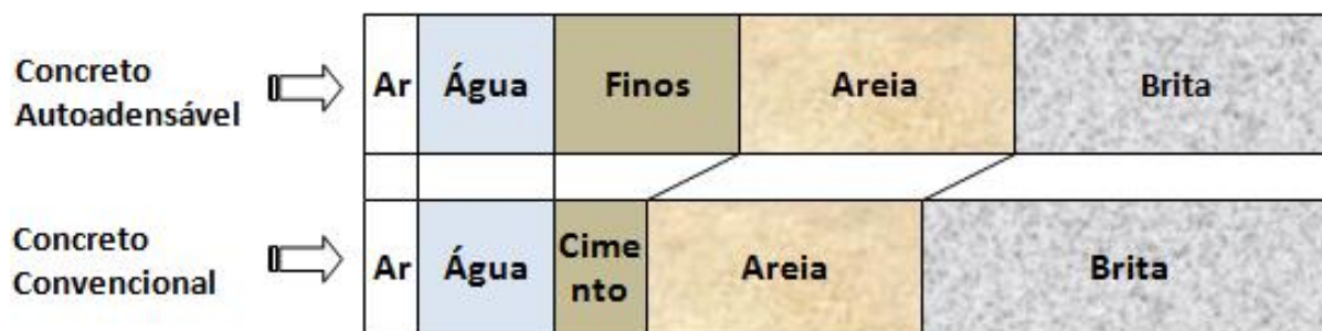
Figura 4 - Comparação do uso de finos no CAA versus Convencional
