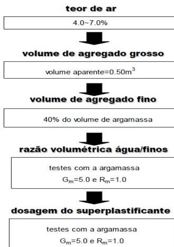
Figura 12 - Esquema simplificado do método de dosagem de Okamura
