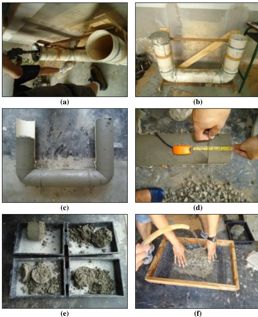
Figura 55 – Ensaio do Tubo-U para o concreto 13
