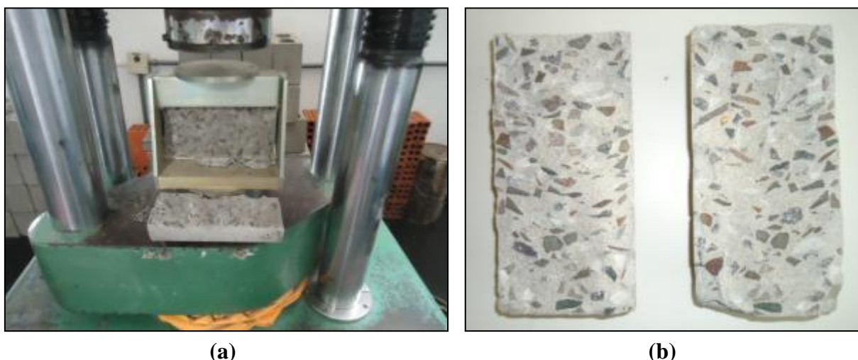
Figura 56 – Ensaio de compressão diametral do concreto 13
