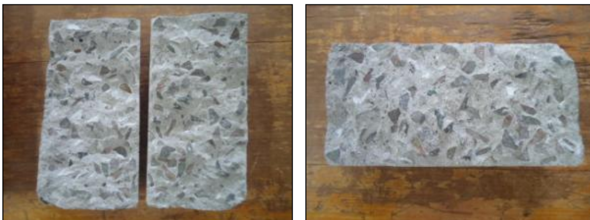
Figura 63 – Corpo de prova do concreto 19 rompido após ensaio de compressão diametral
