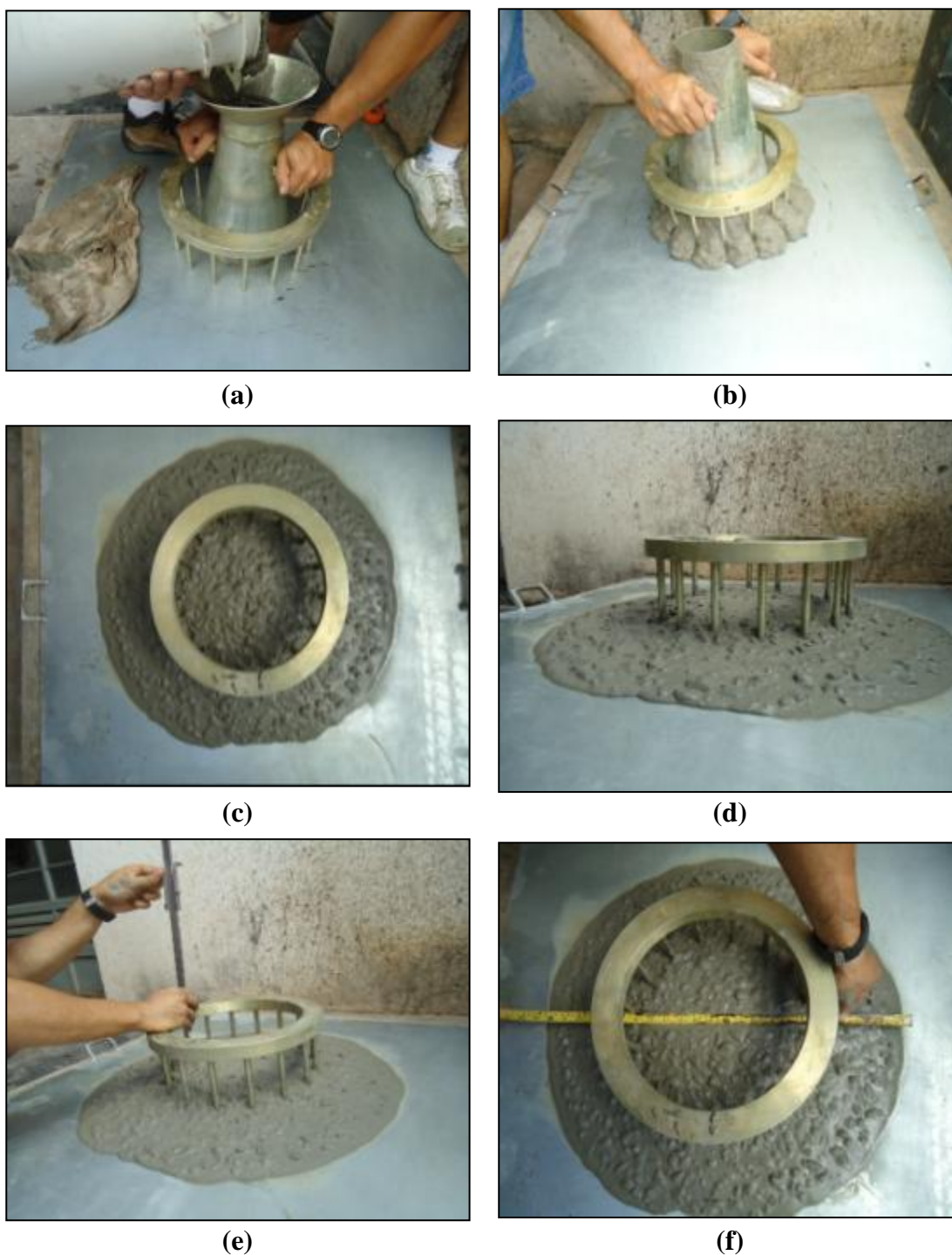
Figura 54 – Ensaio do Anel-J para o concreto 13
