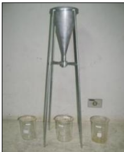
Figura 28 - Funil de Marsh com suporte e béqueres utilizados
