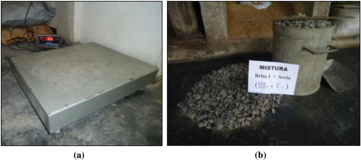
Figura 31 - Dispositivos utilizados no preparo da Massa Unitária
