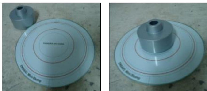
Figura 29 - Mini-cone e placa de vidro utilizados
