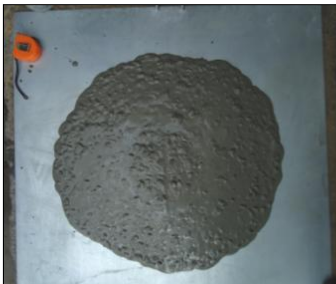
Figura 57 – Ensaio de espalhamento concreto 14
