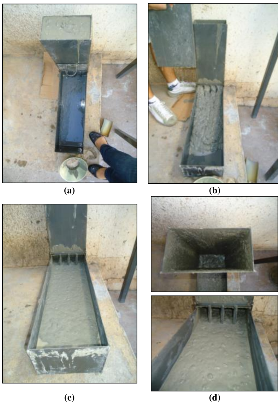
Figura 61 – Ensaio da Caixa-L para o concreto 19
