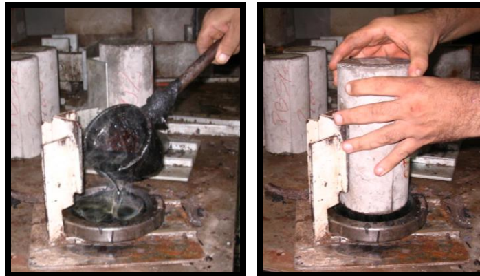
Figura 26: Capeamento do corpo-de-prova
