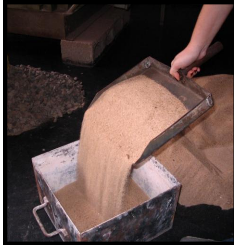
Figura 18 Ensaio da massa unitária solta da areia
