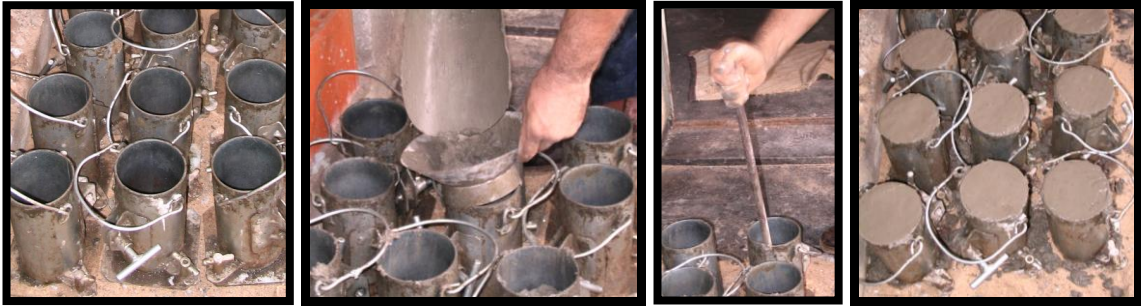
Figura 25: Moldagem dos corpos-de-prova
