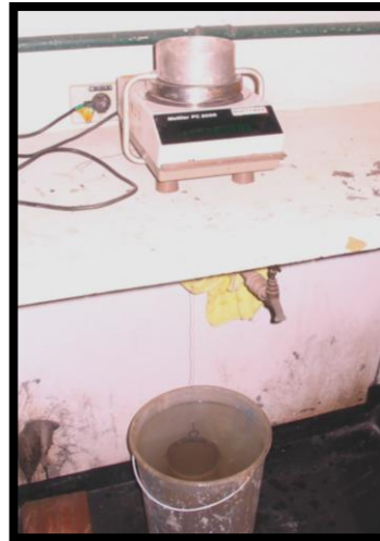
Figura 21: Ensaio da massa unitária do agregado graúdo
