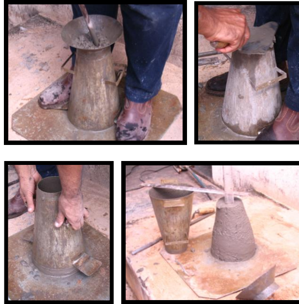
Figura 23: Ensaio de “slump-test”
