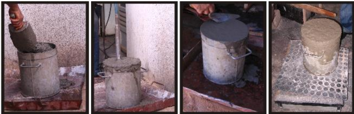
Figura 24: Ensaio de massa específica aparente
