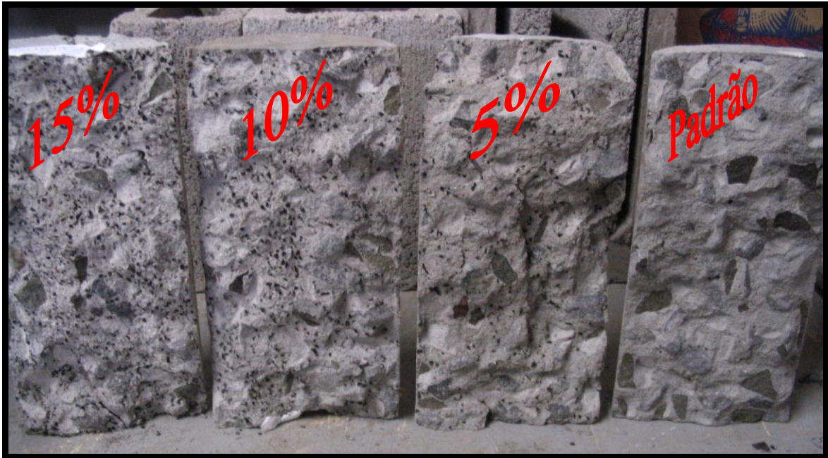
Figura 37: Aspecto interno dos corpos de prova C25
