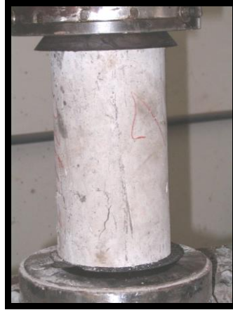
Figura 31: Ensaio de resistência à compressão CB 25 -5% – CP 2
