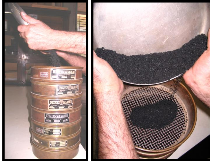
Figura 14: Ensaio de granulometria da borracha de pneu
