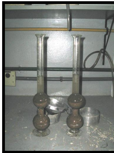
Figura 19 Massa específica através do Chapman
