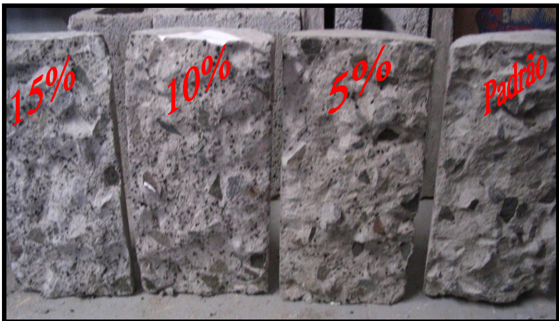
Figura 36: Aspecto interno dos corpos de prova C20
