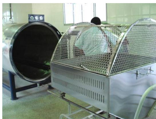
Figura 2 – Cesta para acondicionar o resíduo para tratamento na Autoclave Fonte: Instituto Creatio (2010)
