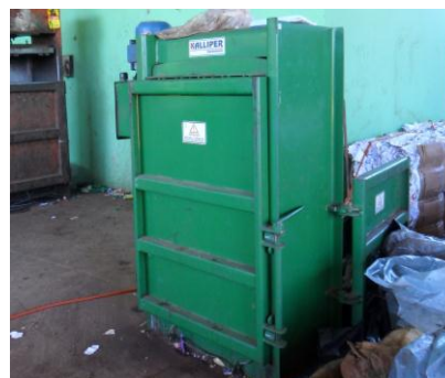
Figura 32 – Prensa utilizada para prensar os materiais recicláveis triados – Astorga/PR
