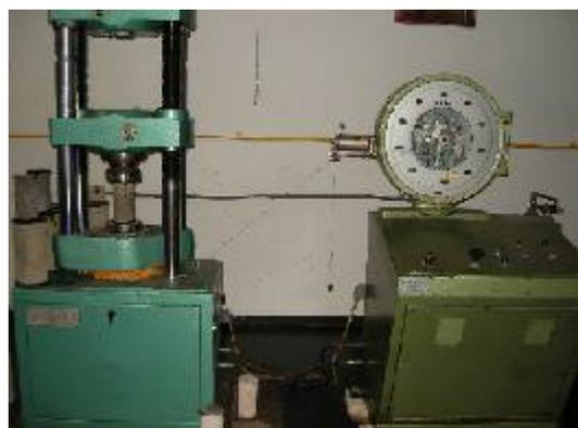
**Figura 18 – Prensa hidráulica de 100 toneladas**
