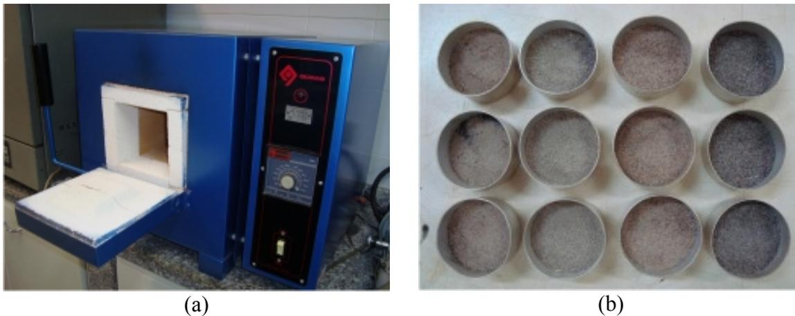
**Figura 19 – Amostras após permanecerem por 1 hora a 550°C em mufla**
