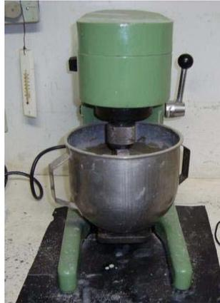
**Figura 14 – Misturador para preparação da pasta**
