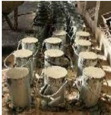
**Figura 17 – Moldagem dos corpos-de-prova**
