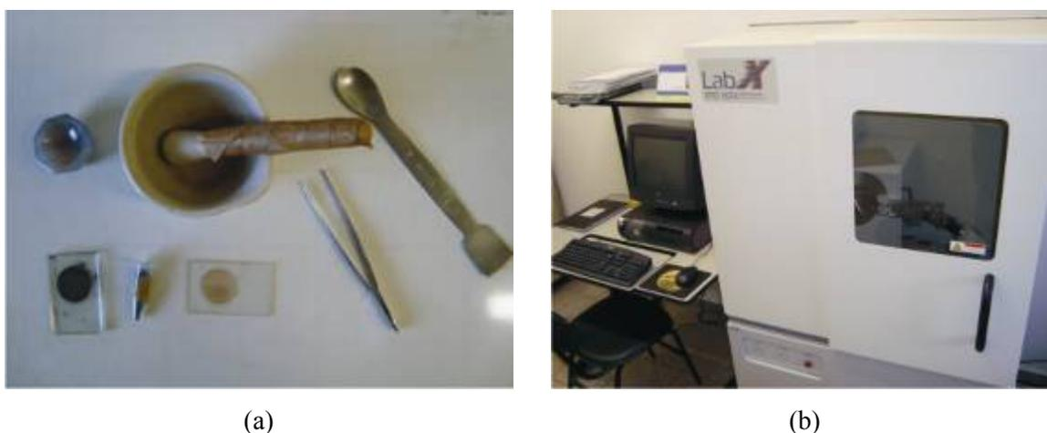
Figura 12: Pistilo, gral e lâminas (a); Difratômetro (b)
