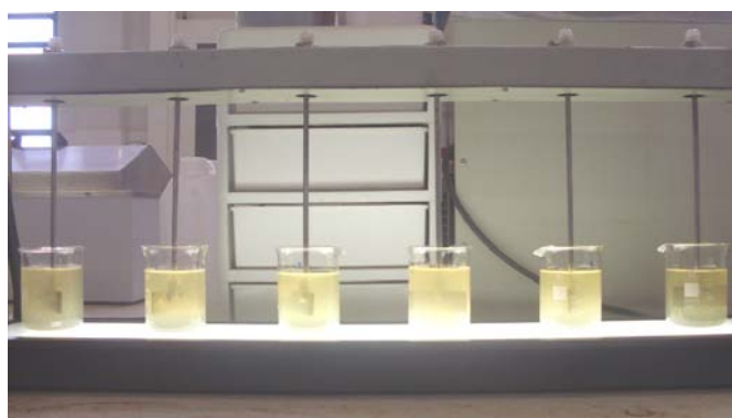
Figura 4.4: Equipamento Jar test utilizado nos ensaios de coagulação/floculação.
