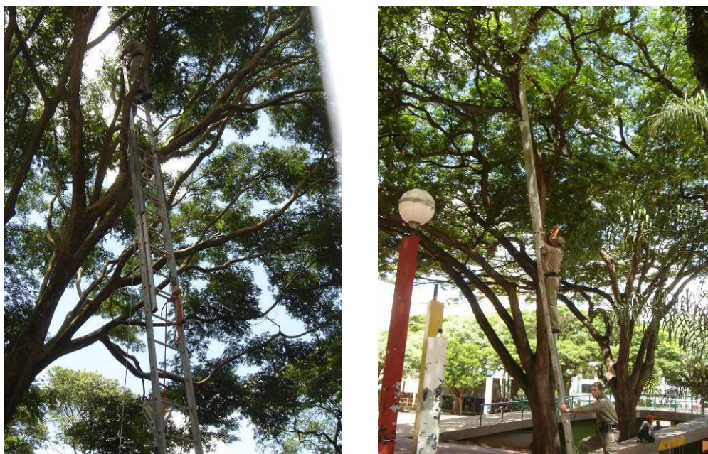
Figura 4.6 – Coleta de dados para a determinação do perfil vertical da velocidade do vento: Praça 1 e Praça 2, respectivamente
