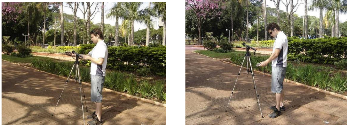
Figura 4.3 – Medição utilizando o equipamento multifunção digital acoplado ao tripé e o termômetro a laser infravermelho, respectivamente
