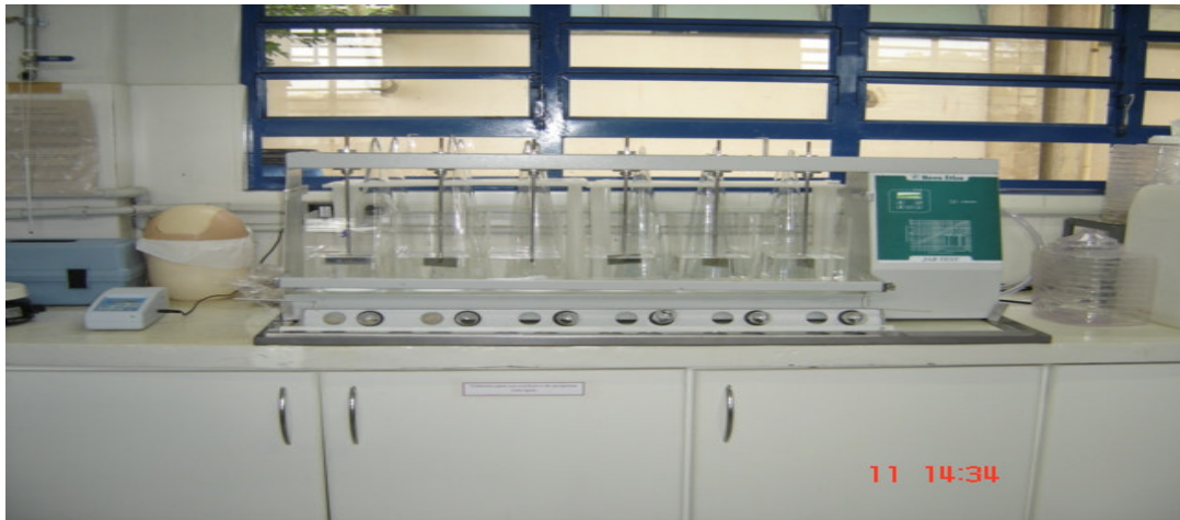
Figura 9 – Equipamento “jar test” utilizado nos ensaios de coagulação/floculação.
