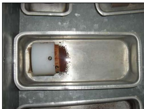
Figura 14 – Disposição do corpo de prova no ensaio de perda de massa por imersão, no detalhe o corpo de prova em seu suporte, disposto no recipiente de alumínio
