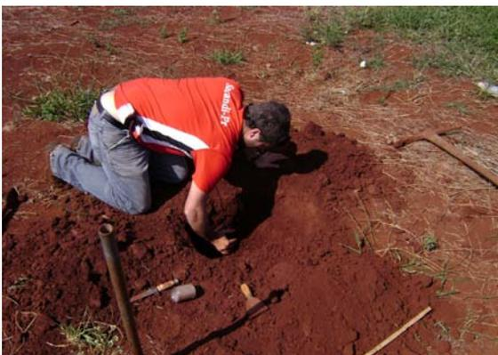
Figura 7 – Detalhe da abertura e preparo da cava para retirada de corpo de prova
