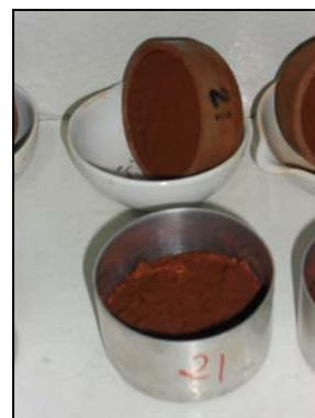
Figura 10 - Anel de PVC com seu corpo de prova faceado e recipiente com a amostra excedente
