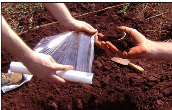
Figura 9 - Coleta do corpo de prova com excedente de material
