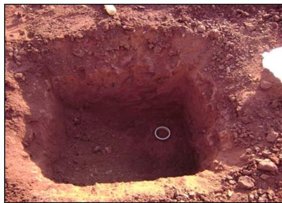
Figura 8 – Detalhe da retirada de corpo de prova no campo, com auxílio da cravação de anel de PVC
