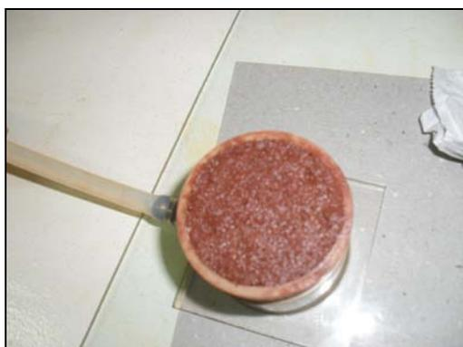
Figura 13 – Corpo de prova saturado, ao final do ensaio de absorção de água
