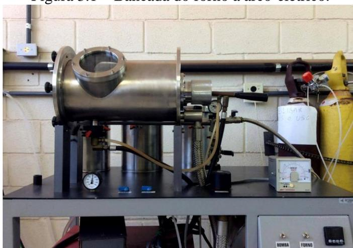
Com os elementos pesados e o forno a arco-elétrico previamente limpo com lixas d'água e acetona, colocaram-se os elementos no cadinho de fusão (Figura 3.2), sendo necessariamente o Gd posto por último – por ter densidade e tamanhos maiores que o Ge e Si, criando, assim, uma barreira capaz de dificultar as estilhas de Ge e Si caindo do cadinho durante a abertura do
