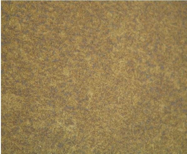
Figura 34 - Aço H13 estrangeiro estado como recebido atacado LePera. Microestrutura bainítica. Aumento 500x
