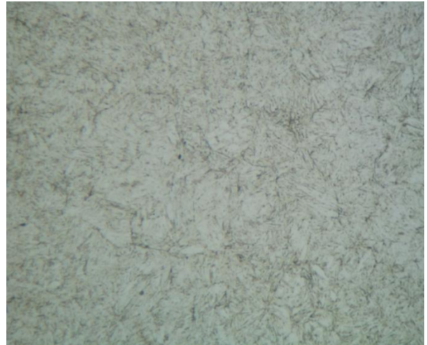
Figura 51 - Aço H13 estrangeiro revenido atacado nital 2%. Homogeneidade da microestrutura Aumento 1000x
