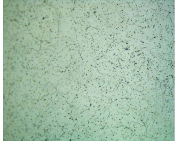
Figura 43 - Aço H13 estrangeiro temperado atacado nital 2%. Aumento 1000x
