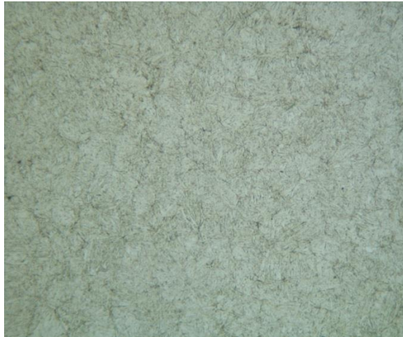
Figura 50 - Aço H13 estrangeiro revenido atacado nital 2%. Homogeneidade da microestrutura Aumento 500x
