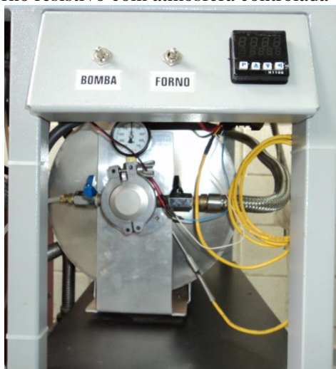
Figura 19 - Visão forno resistivo com atmosfera controlada - Labmat - DEM
