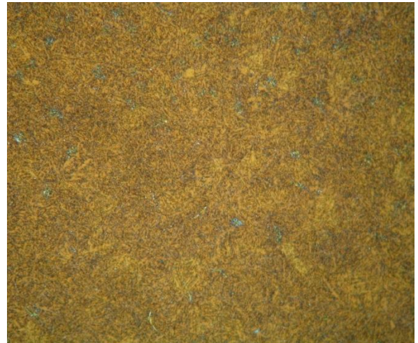
Figura 39 - Aço H13 estrangeiro recozido atacado LePera. Aumento 500x
