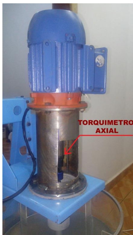
Figura 4.17 – Torquímetro axial de 0,6N.m a 6N.m
