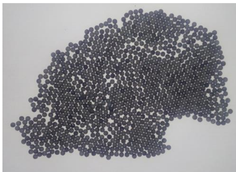
Figura 4.10 – Imagem das esferas de Nylon com diâmetro de 3,175mm
