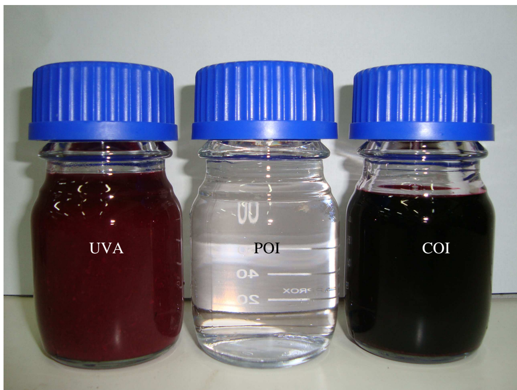
Figura 4.16: Aspecto visual do suco de uva concentrado por OI na pressão de 40 bar a partir do suco MF/UF. Aspecto visual da polpa de uva antes (UVA), do permeado da osmose inversa (POI) e do concentrado pela osmose inversa (COI)
