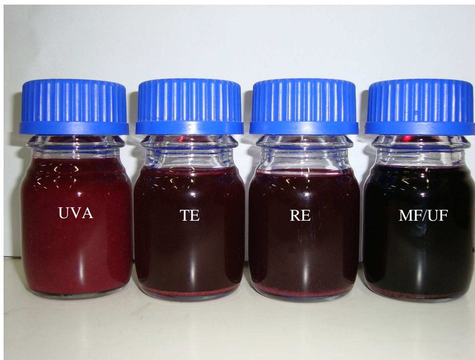
Figura 4.7: Aspecto visual da polpa de uva antes (UVA) e após o tratamento enzimático (TE), e do retido (RE) e permeado (MF/UF) da micro/ultrafiltração
