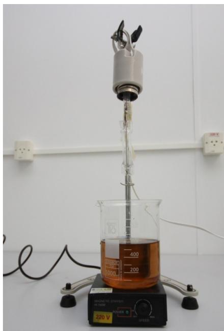
Figura 4.2 – Unidade reacional em sistema batelada, lâmpada (UV).
