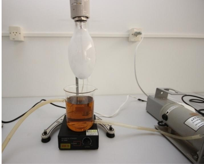
Figura 4.3. Unidade reacional em sistema batelada com reciclo, lâmpada 250 W Visível
