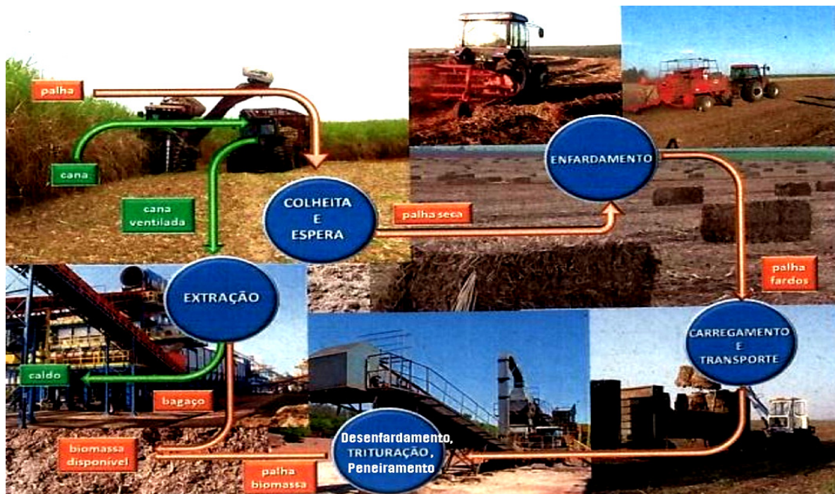
Figura 3.2.3.2 – Processo de recolhimento da palha de cana-de-açúcar (FONTE: CTC e New Holland, 2012)
