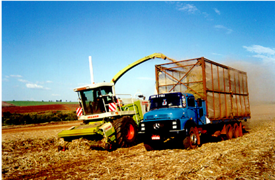
Figura 3.2.3.1 – Processo de recolhimento da palha de cana-de-açúcar (FONTE: FINGUERUT, VIII SHEB, 2005)
