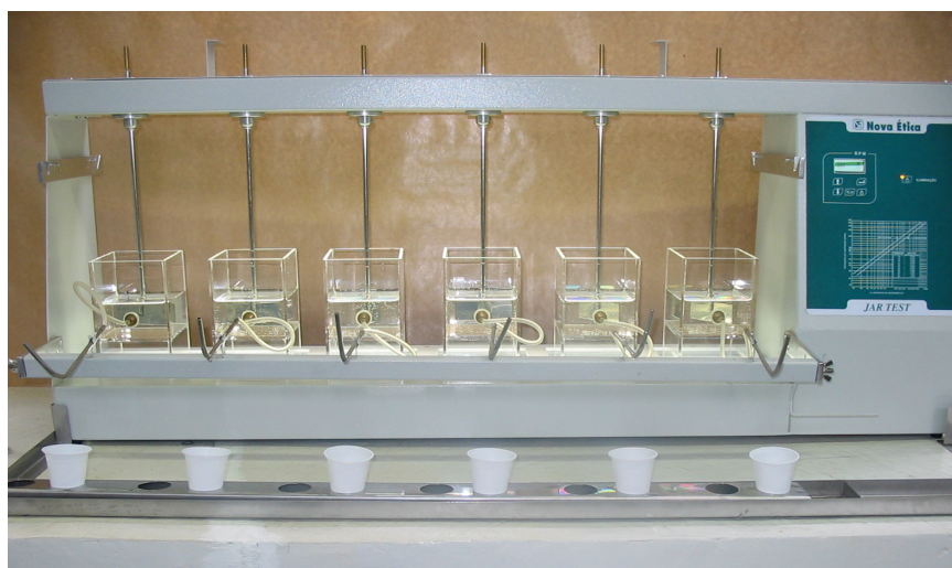
Figura 3.2 Equipamento “jar test” utilizado nos ensaios de coagulação/floculação/sedimentação.
