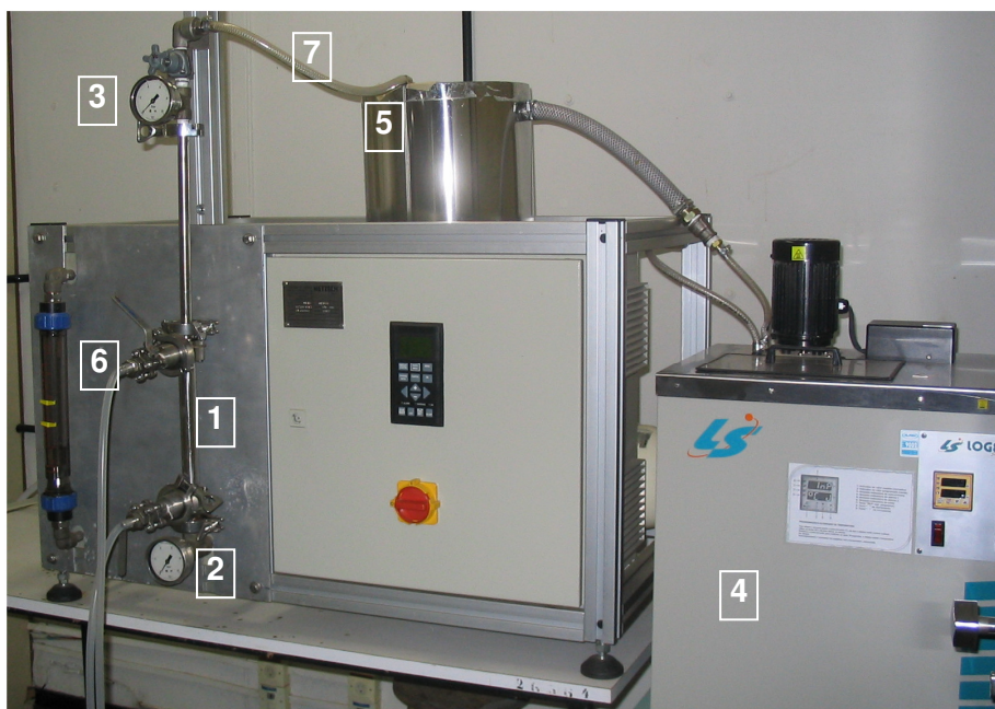
Figura 3.3 Unidade experimental de micro-ultrafiltração.
