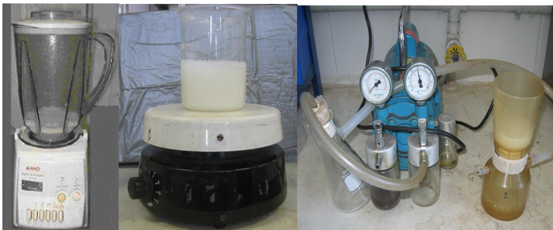
Figura 4.2. Esquema da Preparação da Solução Padrão de Moringa oleifera Lam.
