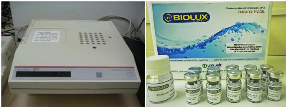
**Figura 3.8** – Analisador Microtox® e bactérias *Vibrio fischeri* liofilizadas.
