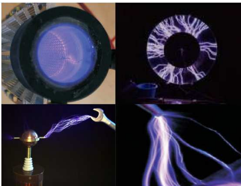
Figura 16. Descargas corona (Fonte: Ozonium Systems , 2011)
