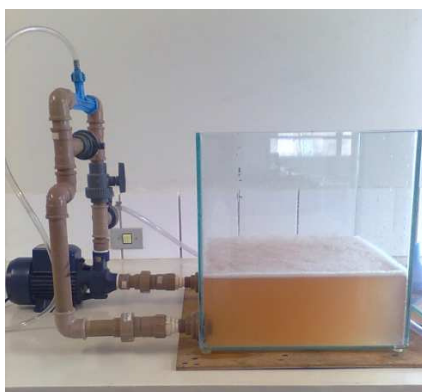
Figura 133. Efluente na cuba de tratamento
