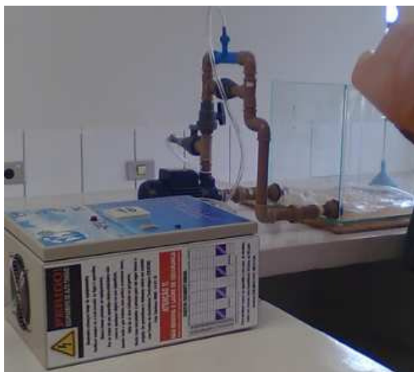
Figura 90. Instalação para ensaio de tratamento de efluente industrial
