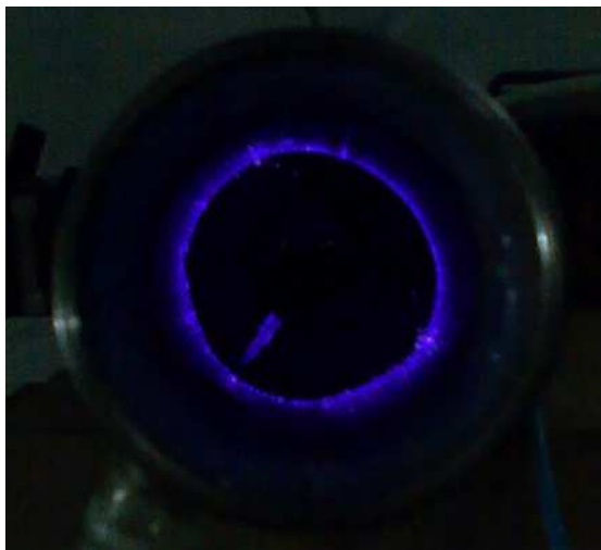
Figura 128. Descarga corona no interior do reator
