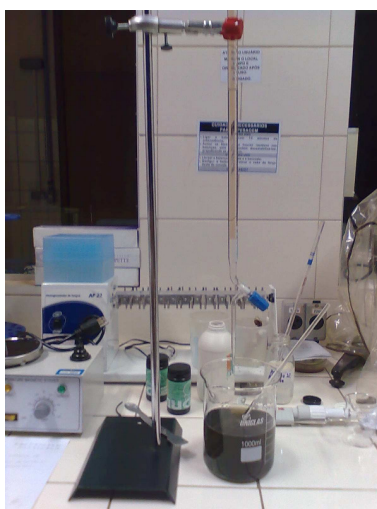
Figura 98. Titulando com tiosulfato após adição do amido
