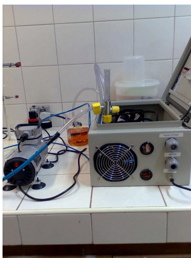
Figura 93. Solução de KI 2% sendo ozonizada
