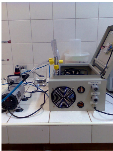
Figura 92. Solução de KI antes do borbulhamento com O 3
