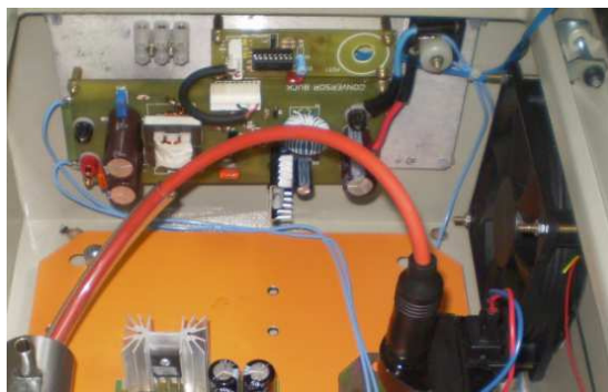
Figura 38. Detalhe interno do gerador com conversor buck com controle analógico
