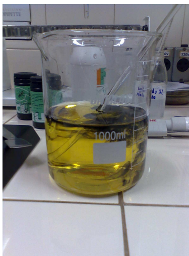
Figura 97. Adicionando amido na solução, após atingir a coloração amarela palha
