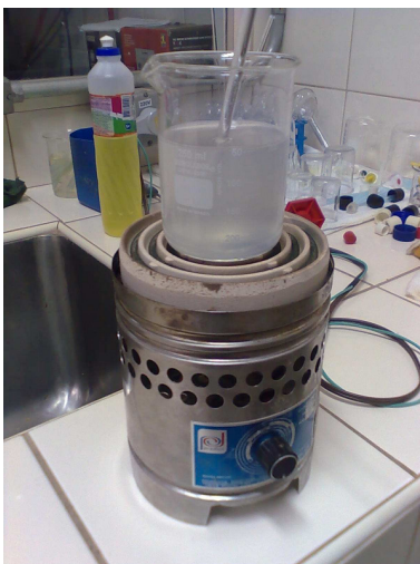
Figura 95. Fervendo a solução de amido por 7 minutos
