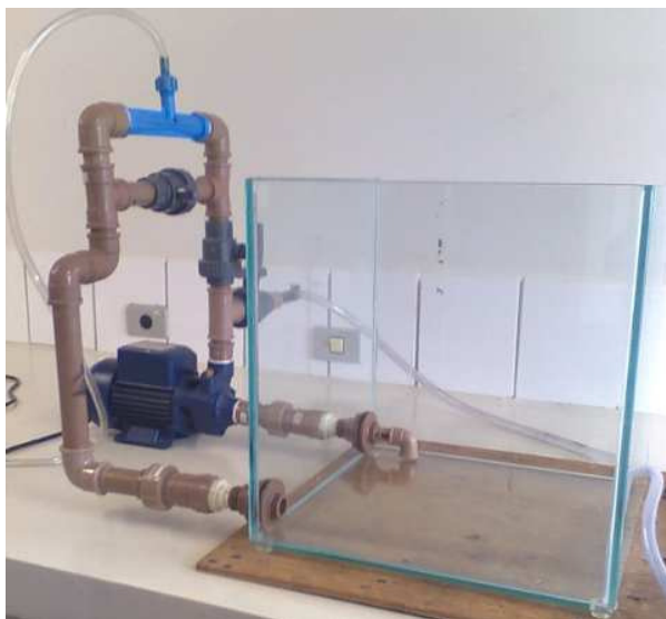
Figura 41. Detalhe da injeção de ozônio pelo venturi
