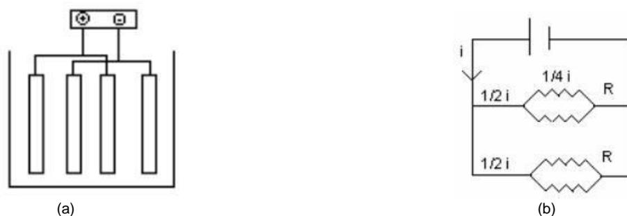
**Figura 5: Esquemas referentes aos arranjos dos eletrodos (a) Reator em batelada com eletrodos monopolares conectados em paralelo. (b) Diagrama elétrico do arranjo monopolar em paralelo (MOLLAH *et al.*, 2004).**
