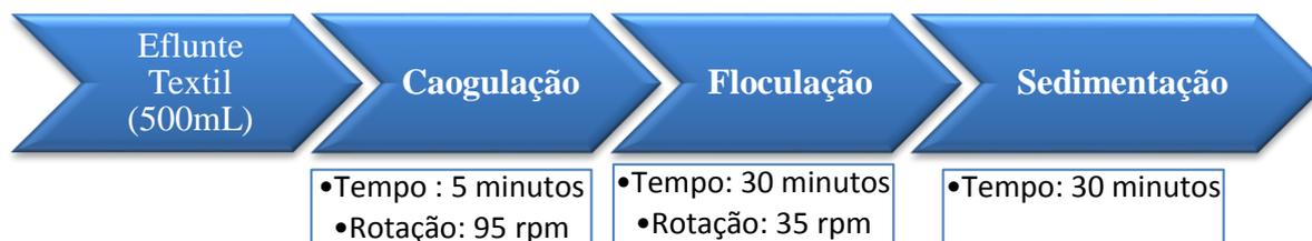
**Figura 8: Metodologia utilizada nos experimentos de coagulação/floculação**
