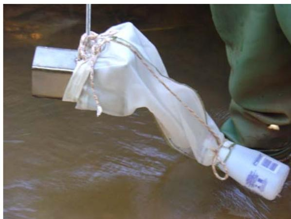
Figura III. 6 – Amostrador utilizado para coleta de material do fundo dos canais, adaptado do amostrador Helley-Smith
