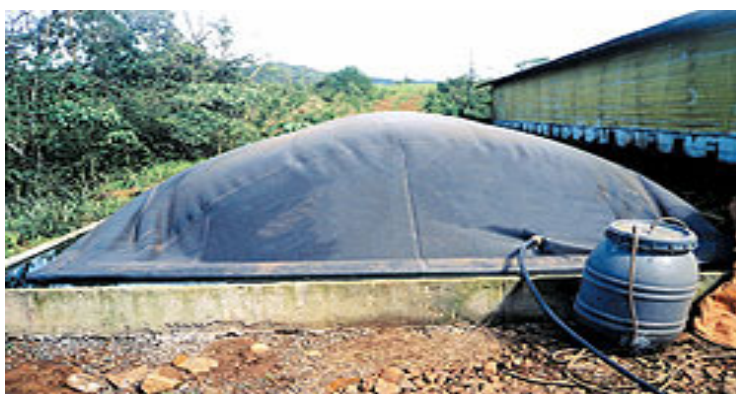
Figura 2.7 - Biodigestor com lona para confinar biogás
