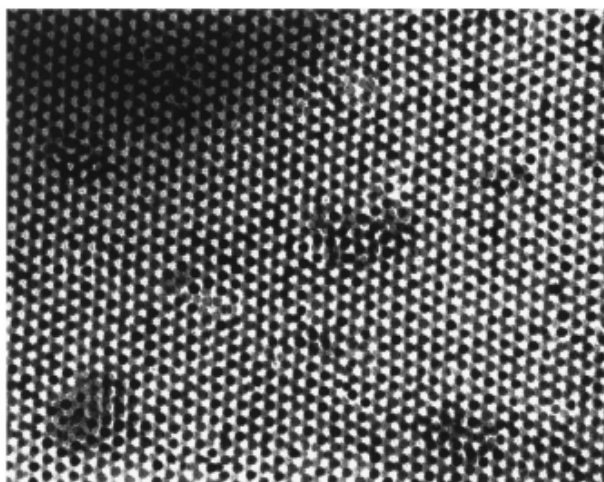
Figura III.8. Imagem de Microscopia Eletrônica de Transmissão do arranjo em 3D de nanocristais de cobalto com 9 nm de diâmetro organizados em um filme de carbono a 70 °C (SUN e MURRAY, 1999).
