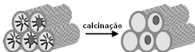
Figura III.13. Esquema do uso de nanopartículas estabilizadas com surfactantes durante a síntese de MCM-41 (NIEDERER et al., 2002).
