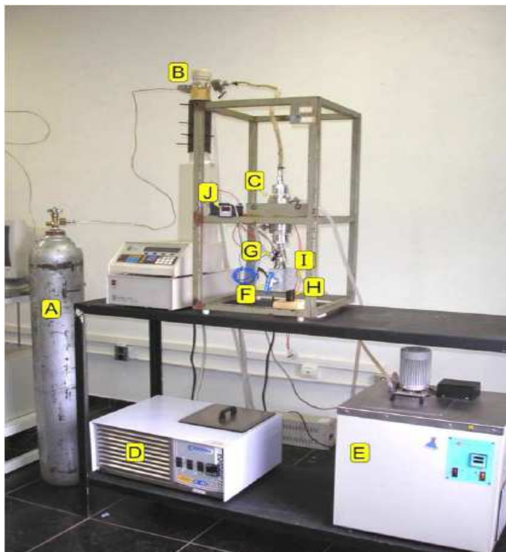
Figura 4.10 - Módulo experimental empregado nos ensaios de extração com fluido supercrítico. (A) Cilindro de gás; (B) Bomba de alta pressão; (C) Extrator; (D) e (E) Banhos termostáticos; (F) Válvula micrométrica; (G) válvula de expansão; (H) Frasco coletor; (I) Saída do óleo; (J) controlador de temperatura.
