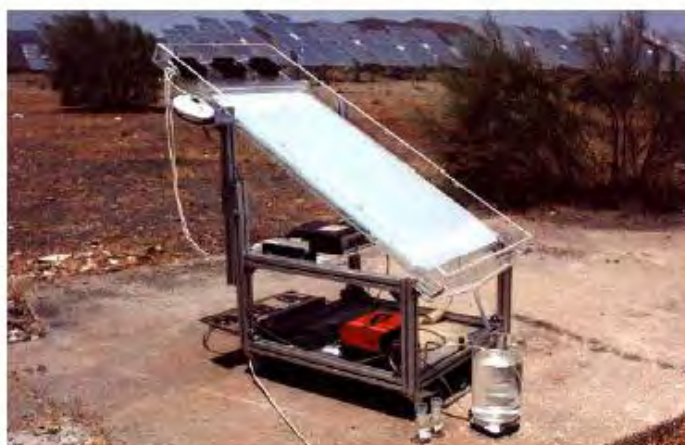
Figura 2. 11. Instalação experimental de um reator de placa plana utilizado pelo ISFH (Institut für Solarenergieforschung GmbH, Hannover, Alemanha) nas instalações da Plataforma Solar de Almería. Fonte: GÁLVEZ et al. (2001b).
