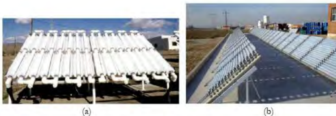
Figura 2. 13. Coletor Cilíndrico Parabólico Composto (CPC) sem concentração solar. (a) Plataforma Solar de Almería. (b) Planta experimental industrial de foto-oxidação catalítica com 100 m 2 de coletores CPC (Madrid). Fonte: GÁLVEZ et al. (2001a).
