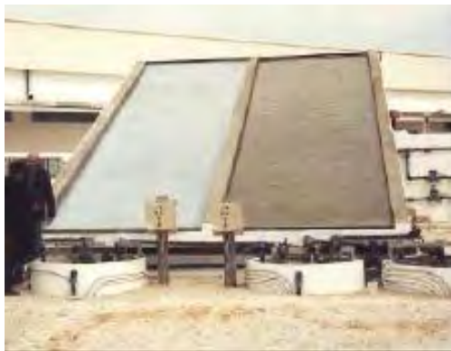
Figura 2. 10. Planta piloto de uma indústria têxtil na Tunísia composta por dois fotorreatores catalíticos tipo TFFBR (Foto: D. Hufschmidt, Universidade de Hannover).
