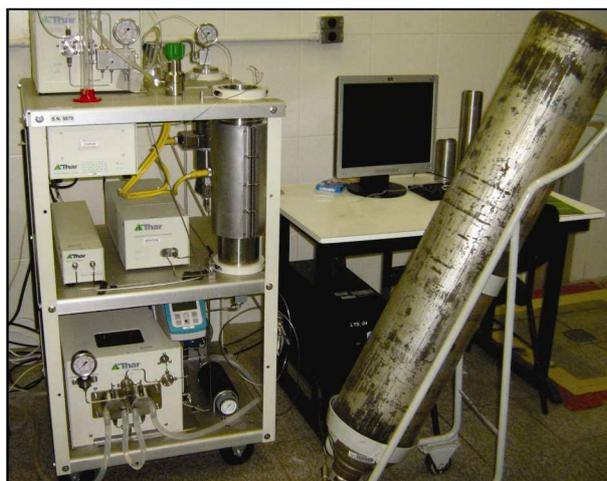
**Figura 5.4** – Imagem real do aparato experimental SAS – THAR.
