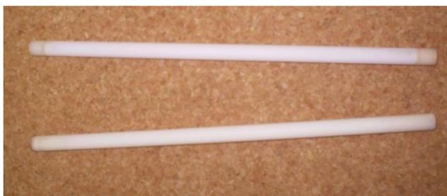
**Figura 25:** Membranas tubulares cerâmicas ( $\alpha\text{-Al}_2\text{O}_3/\text{TiO}_2$ ) com diâmetros de poros de  $0,01$  e  $0,1\ \mu\text{m}$ .
