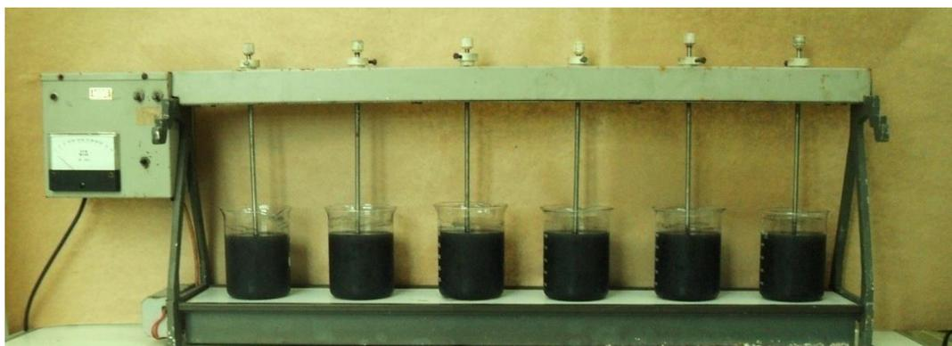
**Figura 24:** Equipamento Jar Test simples, Milan – Modelo JT 101/6.
