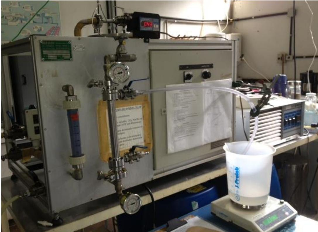
**Figura 26:** Unidade piloto de micro e ultrafiltração (vista frontal).
