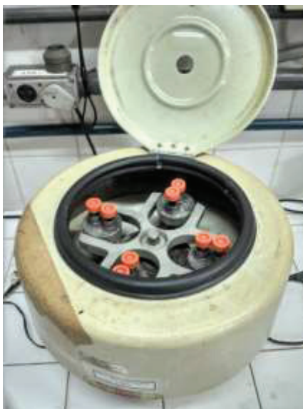
Figura 15 - Centrifugação para separação do óleo da Mo
