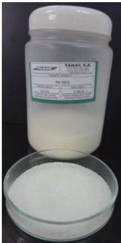
Figura 14 - Polímero aniônico PA 0823 utilizado como auxiliar de coagulação.
