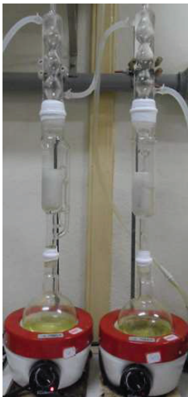
Figura 13 - Extrator de Soxhlet utilizado na extração do óleo.
