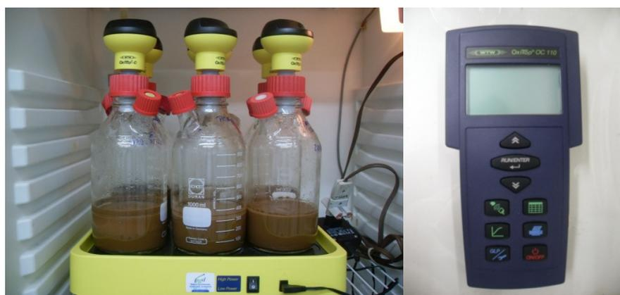
**Figura 7** – Fotografia do equipamento OxiTop OC 110.
