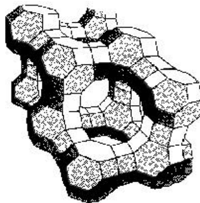
Figura 9. Estrutura da zeólita X (CIOLA, 1981).
