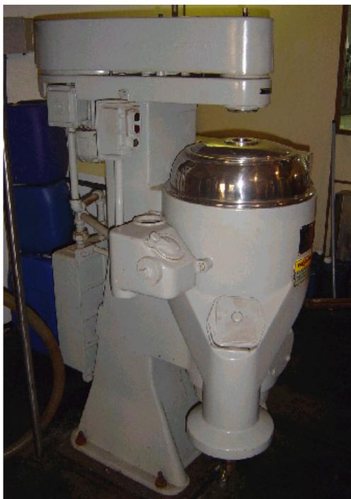
Figura 10: Centrífuga de rotor
