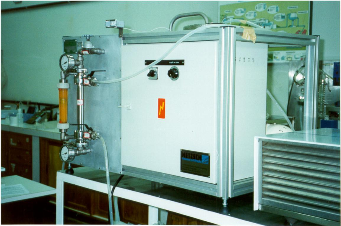
Figura 12: Unidade piloto de micro e ultrafiltração (vista frontal).
