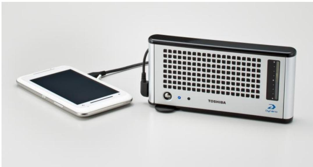
Figura 12 – Dynario – Conectado a um celular e fazendo a recarga da bateria do mesmo.
