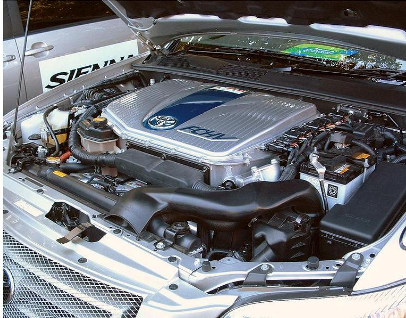
Figura 8 – Carro Toyota movido a Hidrogênio - Toyota FCHV fuel cell vehicle
