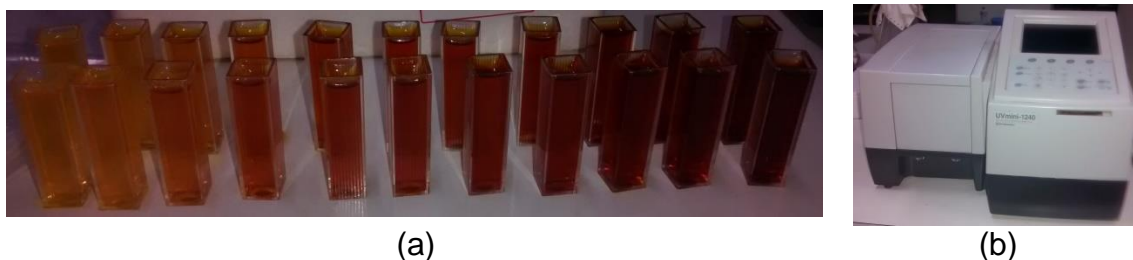
Figura 60: Gradiente de Cor de uma Curva Padrão DNS (a); Espectrofotômetro Shimadzu Utilizado nas Leituras de Absorbância (b). Fonte: O Autor
