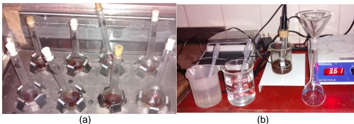
Figura 61: Método de Inversão por Hidrólise Ácida Aplicado em Série: Balões Imersos em Banho a 65 - 70°C (a); Neutralização de Acidez com Uso de pHmetro (b). Fonte: O Autor
