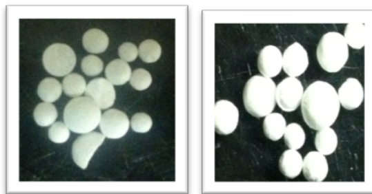
Figura 42 –Fotografia das zeólitas utilizadas após teste fotocatalítico com concentração inicial 10 \text{ mg.L}^{-1} .
