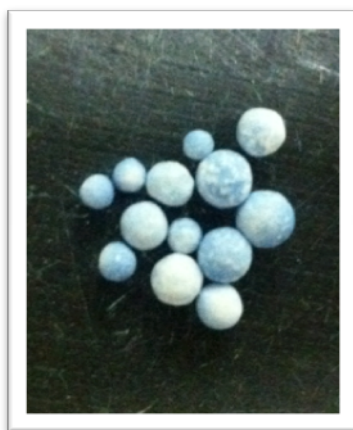
Figura 33 –Fotografia de catalisadores após teste com solução corante a 100 \text{ mg.L}^{-1} .
